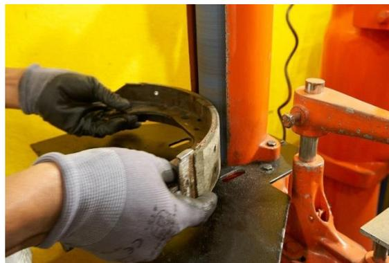
*Nota.* Proceso de remachado de las zapatas del prototipo
