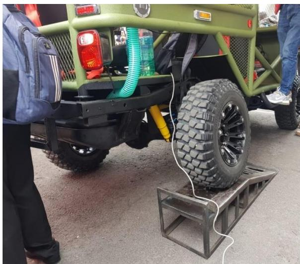
*Nota.* Levantamiento de la rueda derecha trasera con la nueva suspensión.
