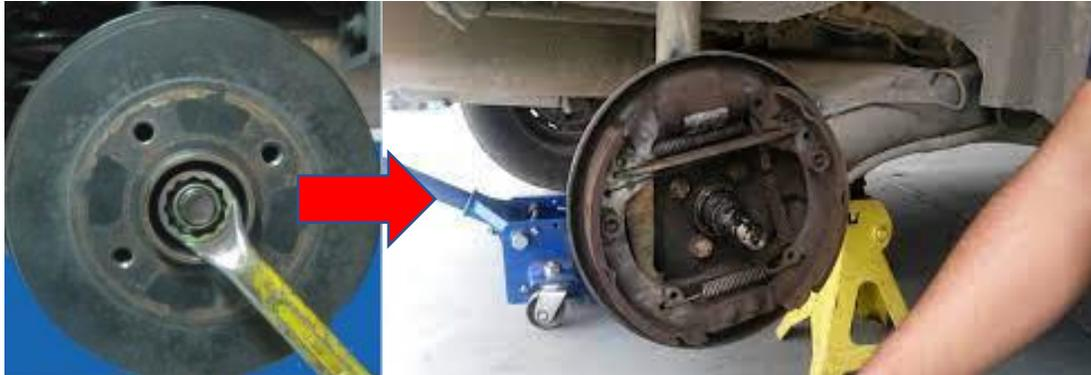
*Nota.* Componentes del sistema de freno por zapata trasero
