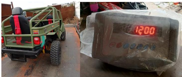
*Nota.* Medición del peso del vehículo en la plataforma
