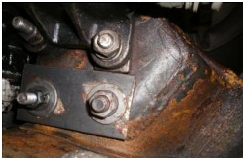
*Nota.* Bases nuevas sujetadas al bastidor del vehículo
