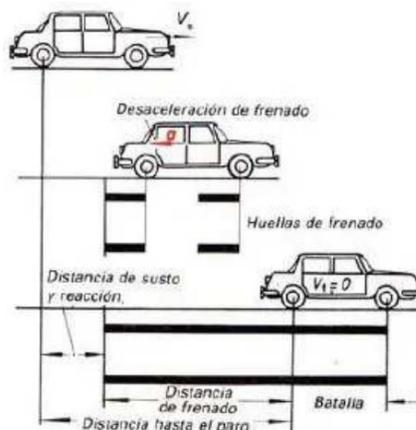
*Nota.* La figura muestra la distancia que aparecen en el proceso de frenado, como las que existen antes de accionar el freno, como las que aparecen al haber accionado el freno.
