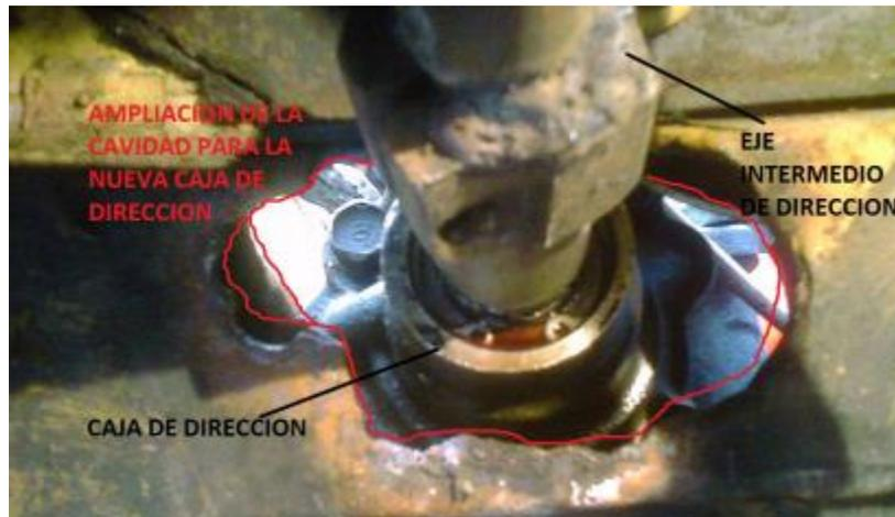
*Nota.* Se aprecia el eje y caja de dirección del vehículo original
