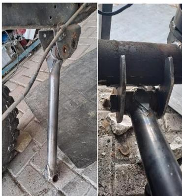
*Nota.* Instalación de los brazos en las nuevas bases fabricadas
