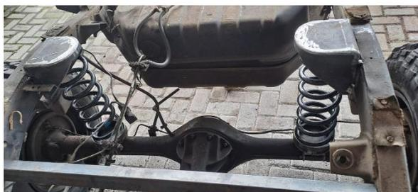
*Nota.* Bases y muelles instalados en el bastidor
