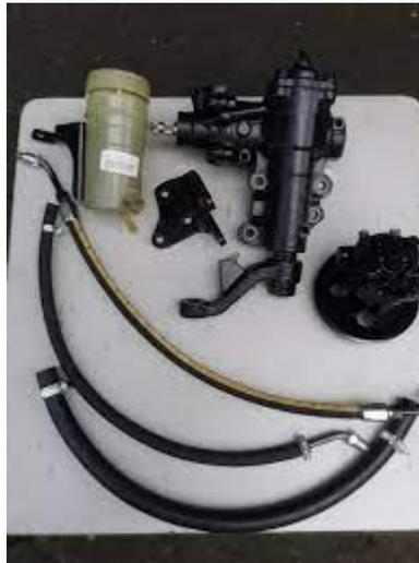
*Nota.* Se puede observar las partes del sistema hidráulico de dirección
