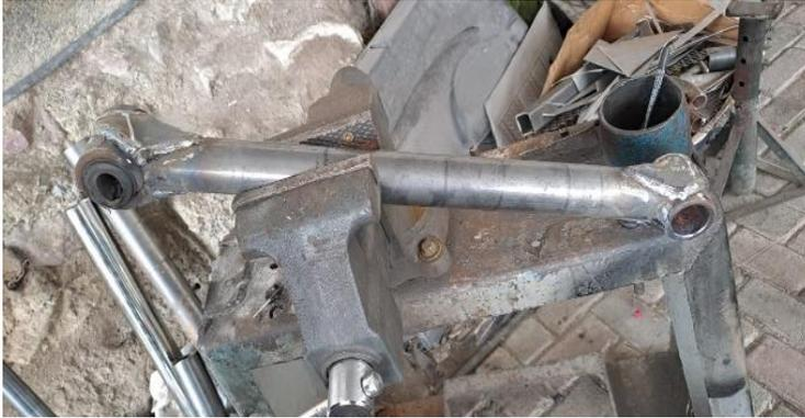
Se necesitan cuatro brazos de suspensión, dos superiores y dos inferiores y que en sus extremos deben ir instalados un par de bujes Off-Road.
