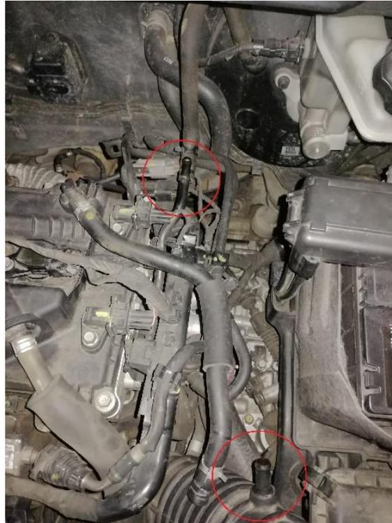
*Nota.* En la figura se observa que la toma de vacío del servofreno y del múltiple de admisión están desconectados, considera la condición de falla afectando la eficiencia volumétrica del ciclo de admisión del motor de combustión interna.
