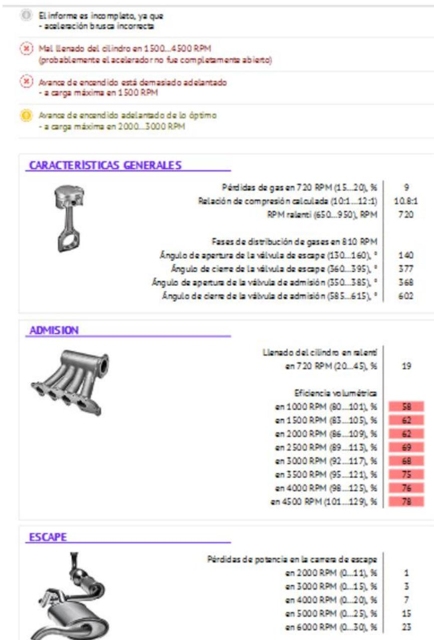
Nota. En la figura se observan los resultados obtenidos del SCRIPT PX en el cilindro 1 del motor en condición de falla el CMP de admisión desconectado, que considera ángulos de cierre y apertura de las válvulas de admisión que se ve afectado por una señal errónea del sensor para el sistema electrónico de la ECU.
