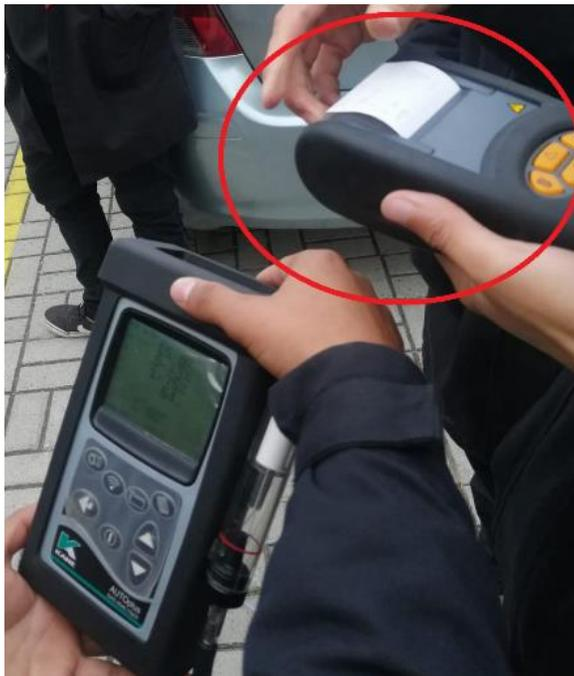
*Nota.* Se observa la ejecución de medición de gases con el Kane plus e impresión del reporte de la prueba.
