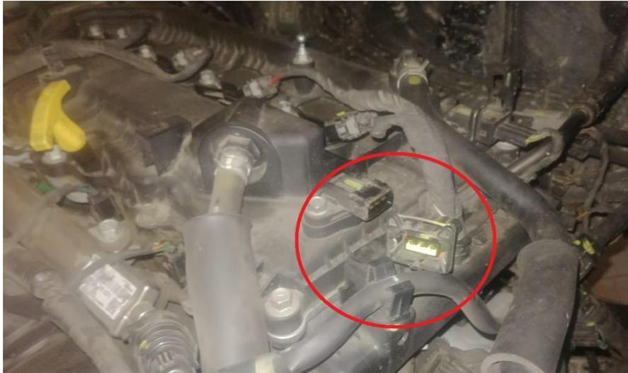
*Nota.* En la figura se observa la desconexión del socket del sensor CMP de admisión, considera la condición de falla de un llenado ineficaz, para afectar la eficiencia volumétrica del motor de combustión interna.
