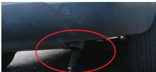
*Nota.* Se observa la forma de instalar la sonda del equipo en el escape del vehículo.
