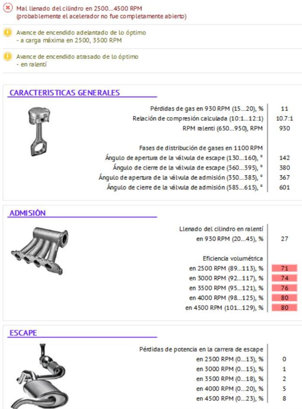
*Nota.* En la figura se observan los resultados obtenidos del SCRIPT PX en el cilindro 1 del motor en condición de falla el escape obstruido, que considera resultados de eficiencia volumétrica que se ve afectado por el llenado ineficiente.
