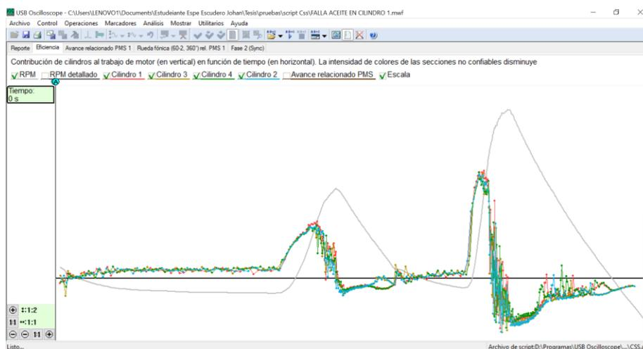
*Nota.* En la figura se detallan los resultados obtenidos del script Css en condición de falla, aceite en el cilindro 1, que considera la relación de compresión en la contribución de los cilindros al trabajo del motor.
