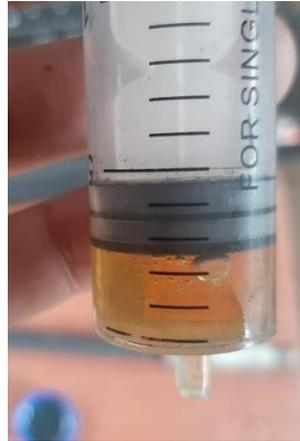
*Nota.* En la figura se observa la carga de 3ml del lubricante en la jeringuilla, que considera la cantidad estipulada para la condición de falla incrementando la relación de compresión.
