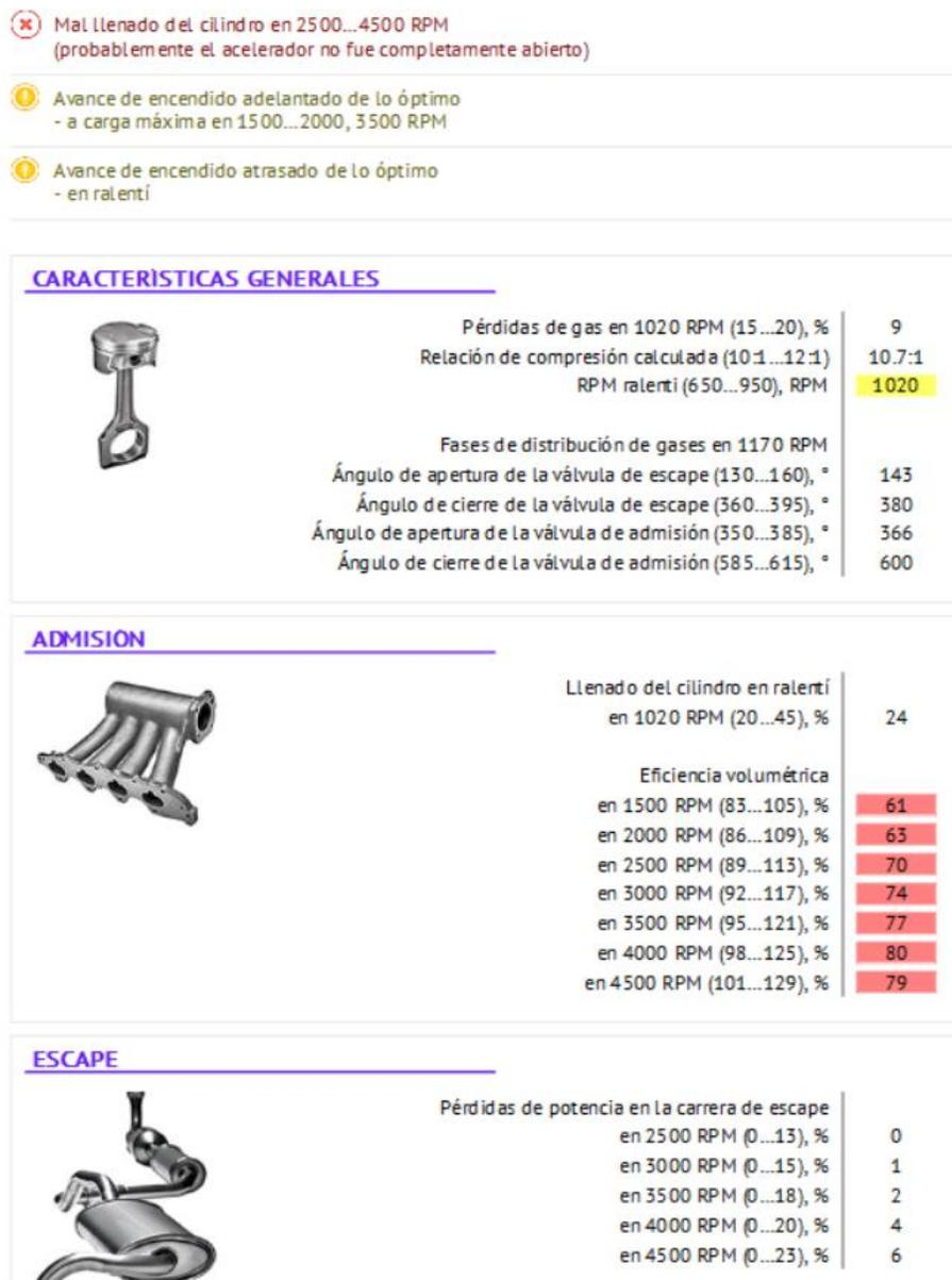
*Nota.* En la figura se observan los resultados obtenidos del SCRIPT PX en el cilindro 2 del motor en condición de falla el escape obstruido, que considera resultados de eficiencia volumétrica que se ve afectado por el llenado ineficiente.
