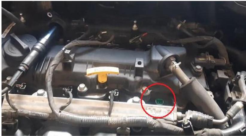
*Nota.* En la figura se observa la desconexión del socket del inyector, considera la condición de falla para un trabajo ineficiente del motor impidiendo el aporte de un cilindro.
