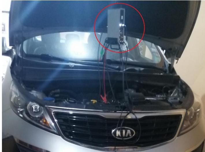
*Nota.* En la figura se observa la ubicación del equipo USB Autoscope IV y accesorios en el vehículo de prueba.
