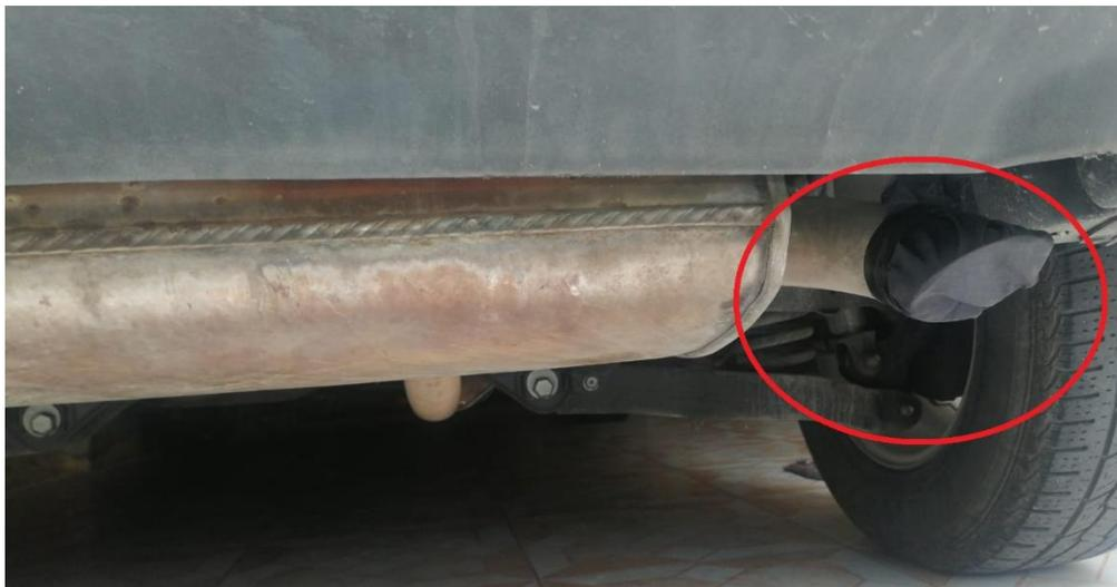
*Nota.* En la figura se observa la obstrucción del escape que considera la ejecución del ensayo de mallado, en la salida de las emisiones post combustión en el tubo de escape.
