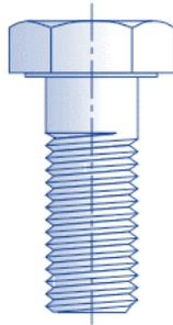
*Nota.* El gráfico representa un tornillo de máquina (capucha). Tomado de *Diseño de máquinas* (p.739), por R.L. Norton, 2011, Prentice Hall
