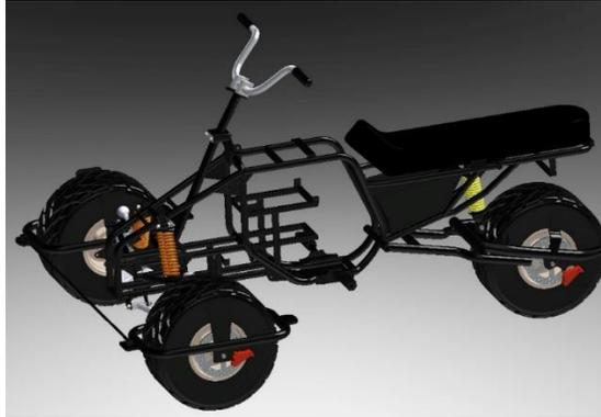
*Nota.* El gráfico representa el modelado CAD del sistema de suspensión delantera, dirección y suspensión posterior.
