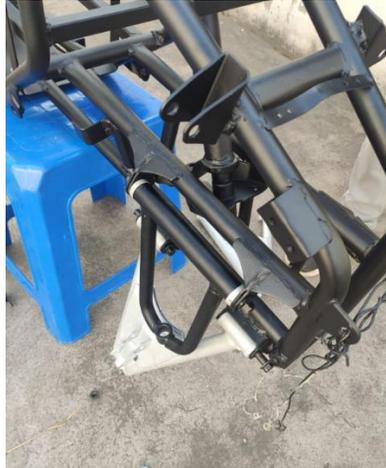
*Nota.* El gráfico representa la elaboración de estos soportes en perfiles, se necesitó un previo análisis en el software CAD, el cual ayudó a diseñar y el lugar exacto para poder colocar estos soportes.
