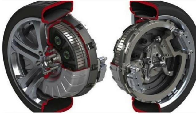
*Nota.* Interior de frenos regenerativos con sus respectivas partes. (Palomino, 2017) Palomino, D. A. (01 de Julio de 2017). *Nitro.pe*. Tomado de Nitro.pe: <https://www.nitro.pe/mecanico-nitro/el-frenado-regenerativo.html>
