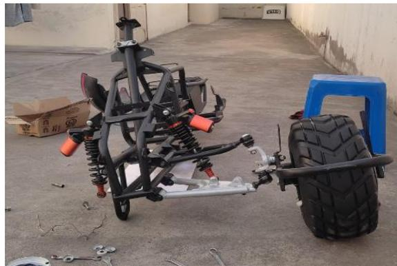
*Nota.* El gráfico representa el ensamble de los sistemas del prototipo como son mesas de suspensión, amortiguadores delanteros, rotulas y rueda con base externa para el disco de freno.
