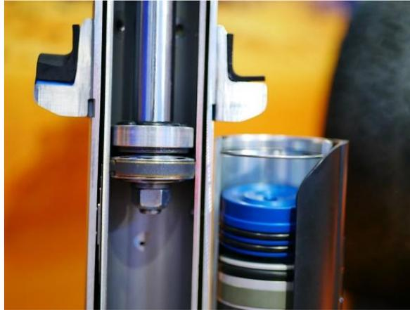
*Nota.* Ilustración interior de un amortiguador de gas. (Teroson, 2004). Tomado de Teroson: <https://blog.reparacion-vehiculos.es/amortiguadores-de-gas-ventajas-e-inconvenientes>
