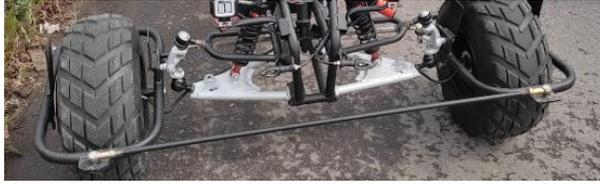
*Nota.* El gráfico representa como se diseñó esta barra para ayudar a la alineación de las ruedas delanteras a más de mejorar la dirección del prototipo.
