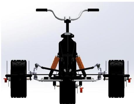
*Nota.* El gráfico representa la implementación del sistema de dirección incorporado en la estructura del bastidor.
