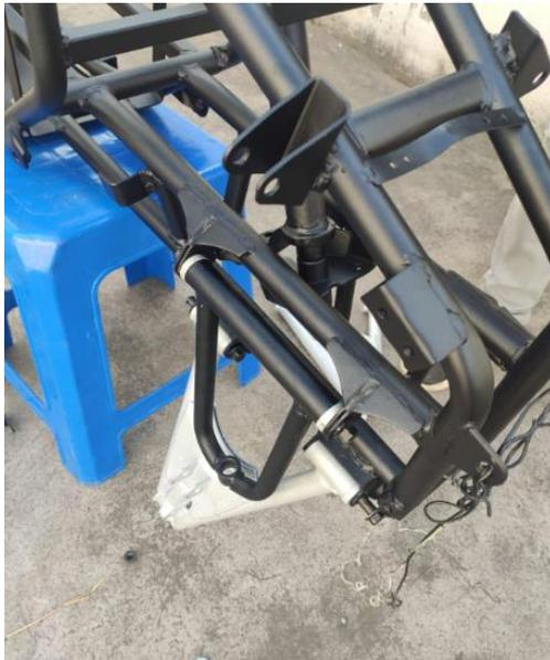
*Ensamble de las partes del bastidor*
