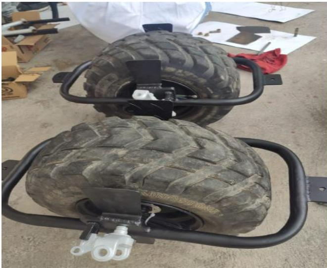
*Estructura para sujeción del neumático posterior*
