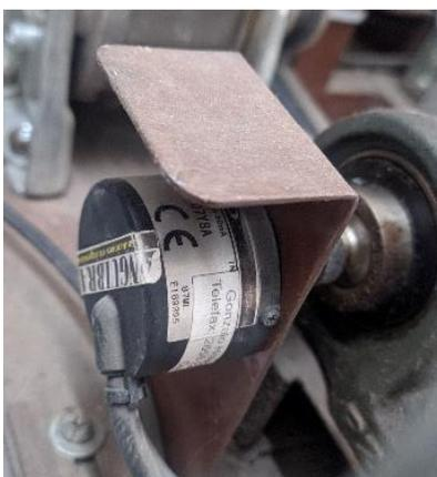
*Nota.* Esta figura muestra el montaje del encoder que esta transmitido mediante un acople hacia la chumacera la cual es accionada por el motor trifásico censando la velocidad.
