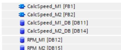
*Nota.* En la figura se indica los bloques de funciones (FB1) y (FB2) denominados CalcSpeed\_M1 y CalcSpeed\_M2 respectivamente, estos a su vez generan automáticamente un bloque de datos (DB11) y (DB14)
