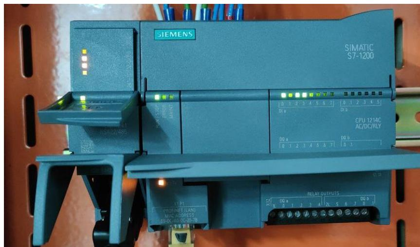
Adicionalmente se conecta al PLC el módulo de comunicación 1214, en la figura 50 se puede observar los pines de conexión del módulo de comunicación que se conectara a la parte izquierda del PLC.
