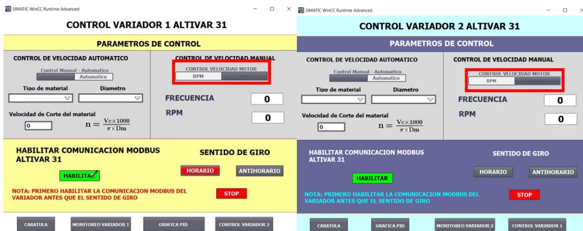
*Nota.* La figura representa la interfaz gráfica HMI, la cual se divide en dos tipos de control: control manual y control automático. En la parte inferior se muestra los botones de activación junto con la nota de importancia para la habilitación de la comunicación.
