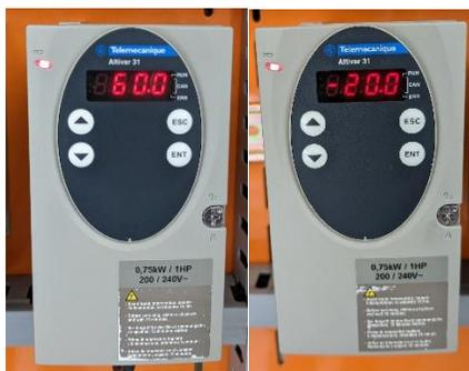
*Nota.* En la figura se muestra la pantalla en los variadores, se identifica que al seleccionar el tipo de giro antihorario se muestra un valor negativo, mientras que al seleccionar el giro horario se muestra un valor positivo.
