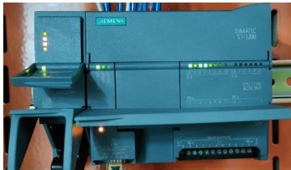
*Nota.* La figura representa al CPU S7-1200 con los leds indicativos activados, los leds de color verde indican la lectura de los encoders los cuales se dirigen a las entradas digitales, mientras que los leds naranjas indican el correcto envío y recepción de datos de la comunicación RS 485.
