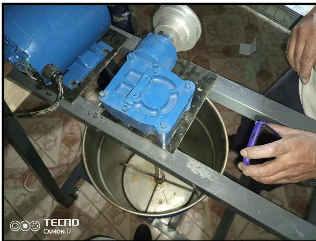
*Nota.* La figura muestra una fotografía de la verificación del centrado del eje al tanque.
