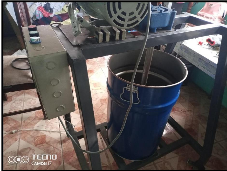
*Nota.* La figura muestra una fotografía de la incorporación del sistema mecánico y de control.
