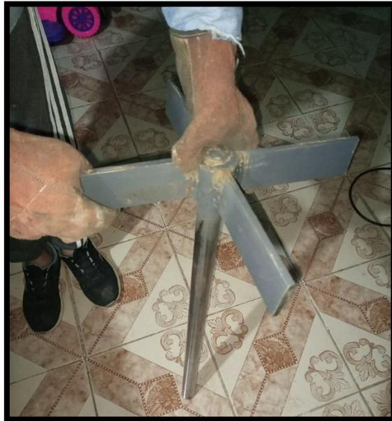
*Nota.* La figura muestra una fotografía del acoplamiento del eje con la turbina.
