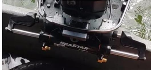
*Nota.* Se puede visualizar en la figura la instalación del cilindro hidráulico en el motor de estribor.
