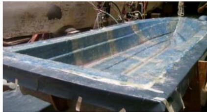
*Nota.* La figura indica el método de disposición manual en la aplicación de la resina y el refuerzo de fibra de vidrio a mano en un molde, obtenido de “*Production Process of Fiberglass Fast Interceptor Boat in Malaysia*”. Tomado de (Yaacob, 2015)
