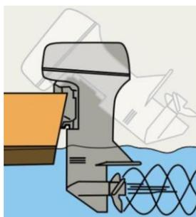
*Nota.* La imagen muestra la ubicación y la función del trimado de un motor fuera de borda, obtenido del “*Boat Safe Workbook*”. Tomado de (Barnes, 2012)
