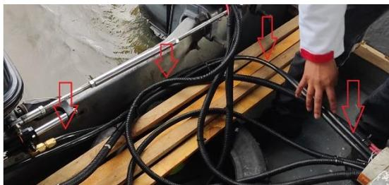
*Nota.* En la figura se observa la manguera hidráulica conectada al cilindro hidráulico.
