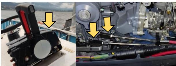
*Nota.* En la figura se observa las cajas de control ubicadas en el panel de control y cables de control.
