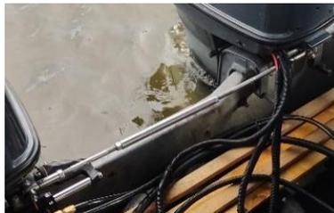
*Nota.* Se puede observar en la figura la varilla de sujeción instalada a los dos motores.
