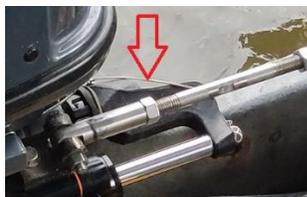
*Nota.* Se logra visualizar en la figura la correa a tierra implementada en el cilindro, sin restricción alguna.
