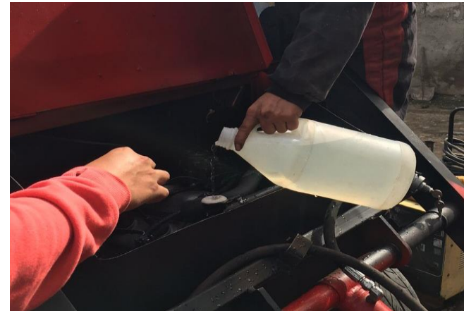
Carga de fluido al sistema de refrigeración
