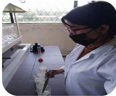
Se introdujo los electrodos de pH electrónico
