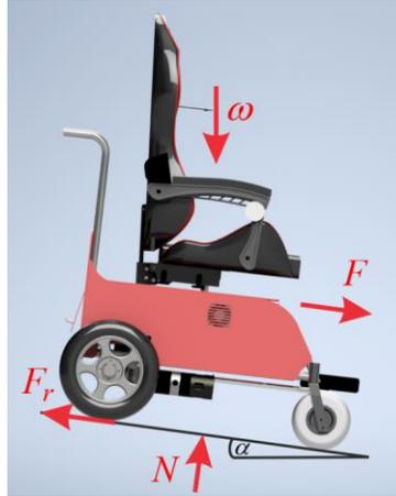
**Condición estática.** El robot se encuentra en estado de reposo. Realizando la sumatoria de fuerzas en el eje “y” se obtiene nuevamente la siguiente ecuación (7).
