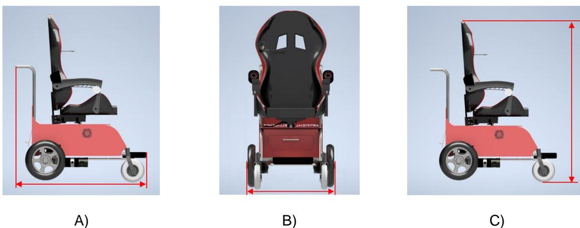
*Nota.* Largo de 1100 mm, ancho de 680 mm y alto de 1350 mm.
