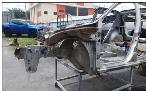
*Nota.* En la imagen se observa la carrocería activa para la preparación del proceso de masilla y lijado.
