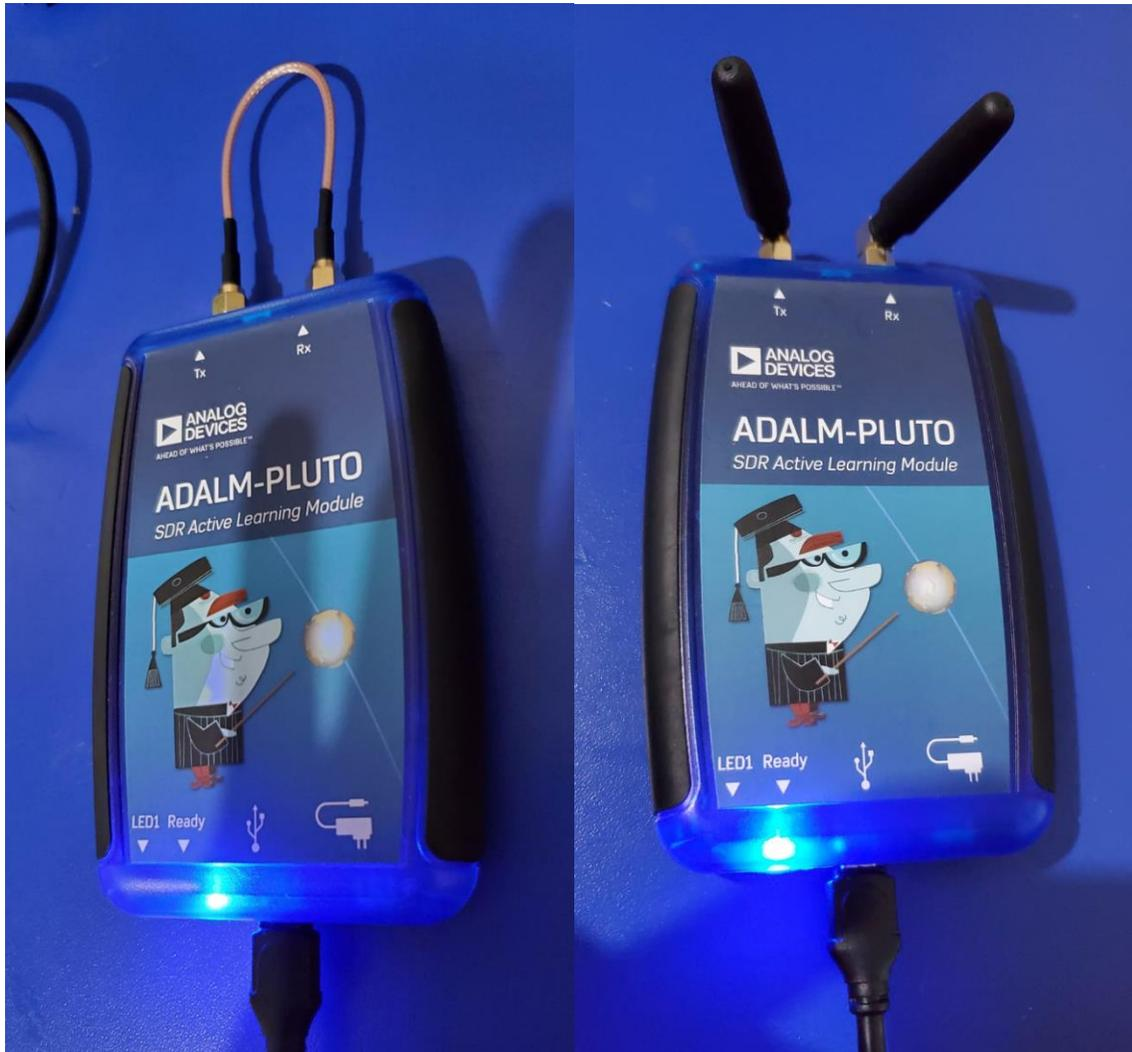
*Nota.* El método de canal a) es mediante cable coaxial, el método b) de canal inalámbrico mediante dos antenas.
