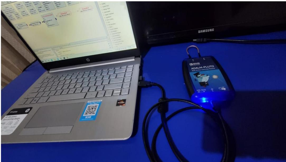
En las pruebas se realiza la transmisión y recepción a través del mismo dispositivo Adalm Pluto, las pruebas son realizadas en un ambiente controlado o sin interferencias, dado que el primero método de canal para pruebas será realizado a través de un cable coaxial entre el terminal de transmisión y recepción, el segundo método de pruebas será mediante dos antes
