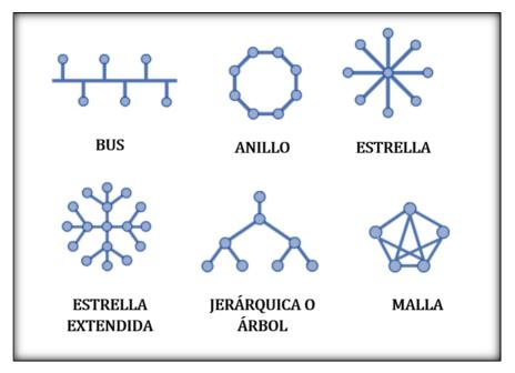
Nota. La figura muestra las diferentes topologías de las redes. Tomado de (ConoceSobreInformática, 2019).
