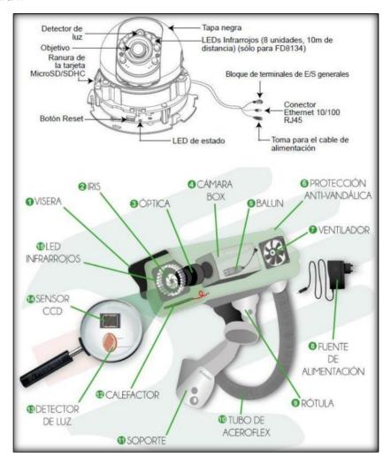
Nota. La figura muestra dos cámaras IP con sus partes. Tomada de (OVACEN, 2021)
