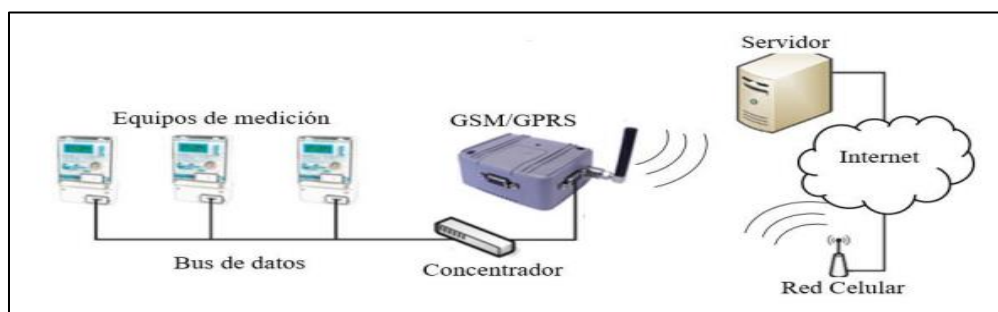
Estructura de telemedición
