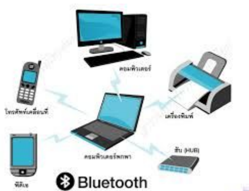
Figura 2. Esquema de Red PAN
