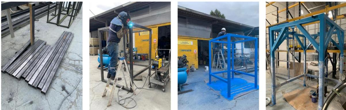
*Nota.* Las fotografías muestran los tubos cortados, proceso de soldadura y pintura.
