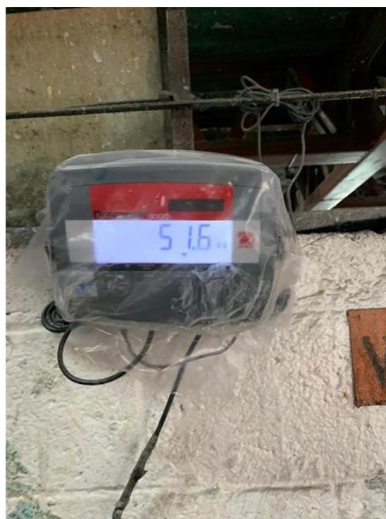
*Nota.* Se muestra además una ampliación de la pantalla digital indicadora de la masa de aditivos medida en barriles plásticos.
