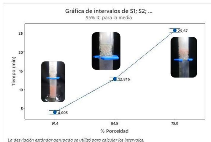
Si bien es cierto es un método experimental para evaluar la permeabilidad, éste brinda una visión general de la relación directa que existe entre el porcentaje de porosidad y la permeabilidad de la estructura (Figura 37).
