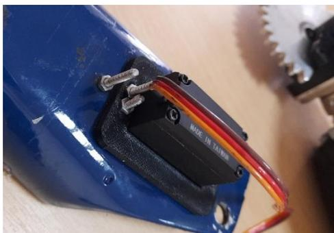
Estos elementos tanto de protección como sujeción fueron fabricados empleando manufactura aditiva y para la selección del material de fabricación se considera las características físicas y mecánicas de diferentes filamentos disponibles en el mercado.
