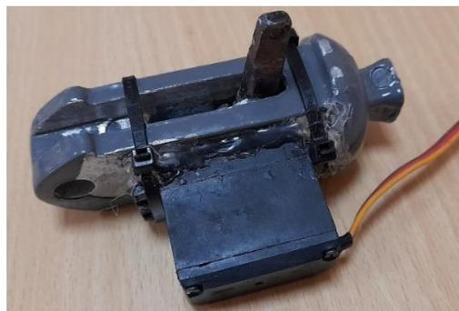
Como se puede observar en la **Figura 26**, identificamos que el servomotor encargado de accionar el mecanismo de articulación de tobillo se encontraba sujeto al elemento mecánico empleando silicona y correas plásticas; esto no brinda seguridad alguna sobre el mecanismo y su funcionamiento pues compromete notablemente la precisión de los movimientos y estabilidad del sistema.
