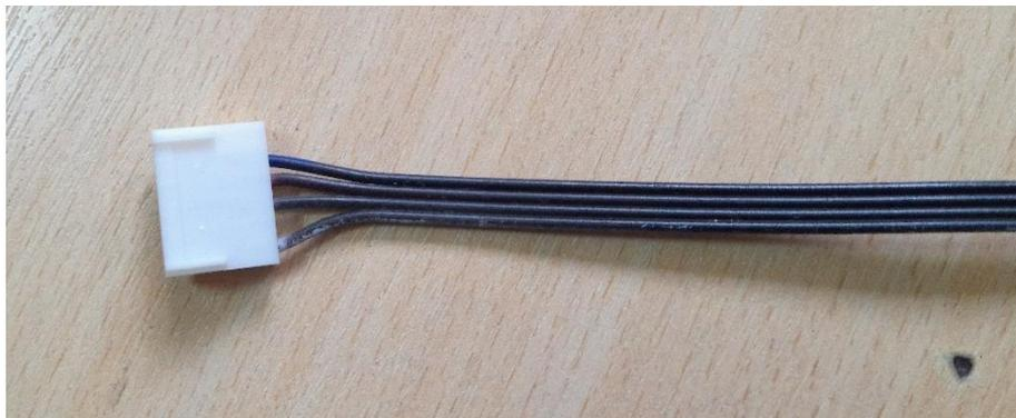
*Nota.* Se eliminó los conectores IDE de 10 pines, extendiendo las conexiones requeridas (4 pines) hasta conectores JST de 6 pines en los que se conectarán los sensores anteriormente indicados.
