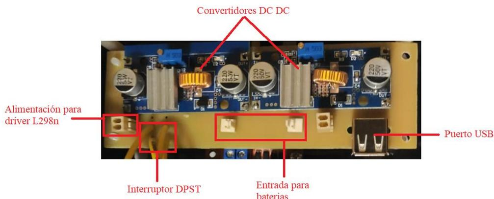
Como se puede observar en la Figura 38 se encuentran montados los convertidores DC DC, y los diferentes elementos para la distribución de voltajes como se habló en el capítulo III. Durante el proceso de pruebas del robot la placa se desempeñó de acuerdo a los parámetros establecidos previamente puesto que la corriente que fluye por la placa no supera las corrientes nominales de los convertidores.
