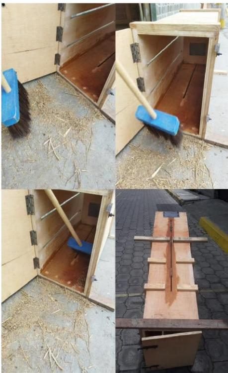
Después de que se haya obtenido el fardo se procede a realizar la limpieza de la máquina con una escoba, el cajón de compresión deberá quedar completamente limpio y libre de paja, esto con la finalidad de que la placa de compresión se desplace con facilidad al realizar un enfardado más. Si es necesario se colocará aceite modernamente y con una esponja en las tuercas inferiores de la máquina que unen al panel de compresión y en la tapa inferior de la misma.
