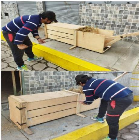
Con ayuda de una varilla de 8 mm de diámetro y una longitud de 1 m, se realiza el ordenamiento de la paja dentro del cajón de compresión. Cuando la paja es ingresada a la máquina se introduce la varilla por una de las aberturas laterales con la finalidad de evitar que los tallos caigan de forma horizontal dentro del cajón y así mantener su verticalidad durante la compresión.
