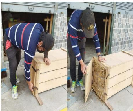
Una vez que se ha terminado de realizar los nudos y el panel de compresión se haya desplazado hacia atrás, se procede a levantar los seguros de la puerta principal de la máquina, para posteriormente realizar el proceso de retirado del fardo.
