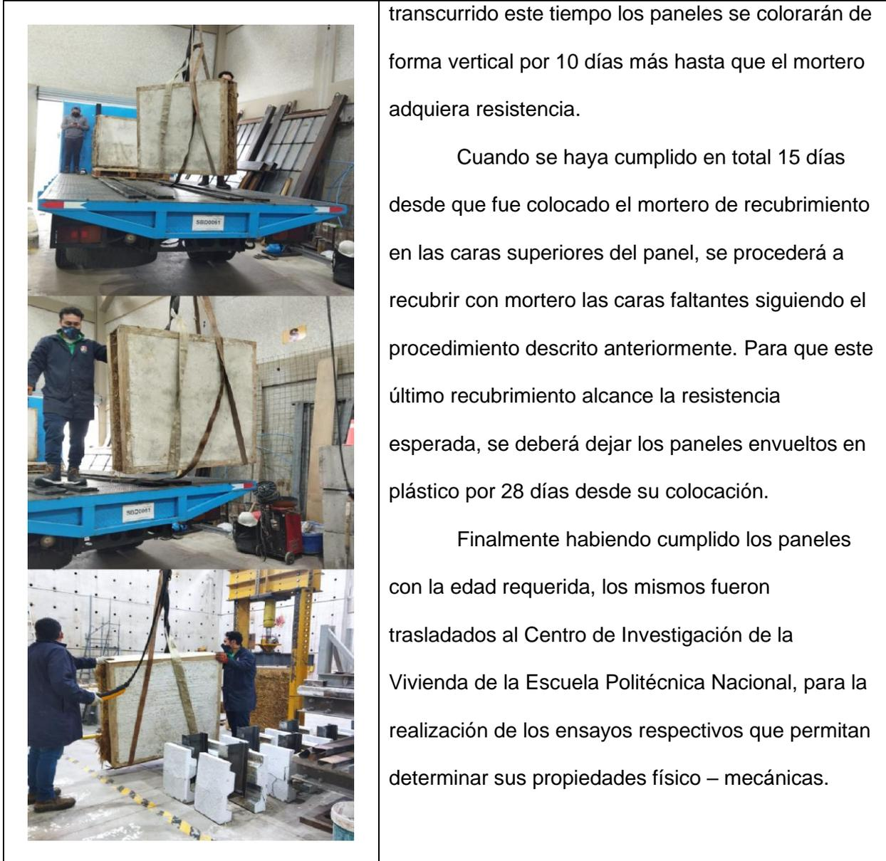
transcurrido este tiempo los paneles se colorarán de forma vertical por 10 días más hasta que el mortero adquiera resistencia.
