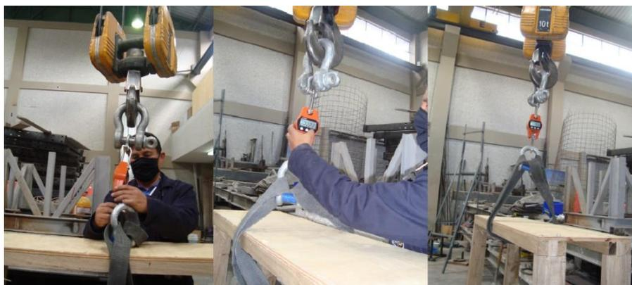
En la tabla 59, se muestra la masa obtenida para cada uno de los paneles compuestos por marcos de madera, fardos de paja y recubrimiento a base de cal y cemento.
