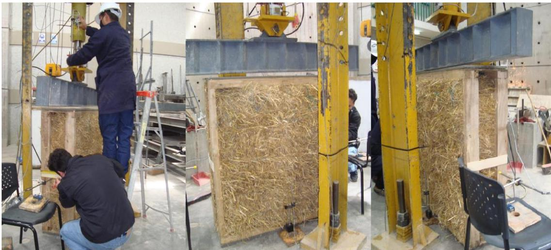
En la tabla 67 se muestra los esfuerzos a compresión corregidos por esbeltez de los tres paneles compuestos por marcos de madera y fardos de paja.
