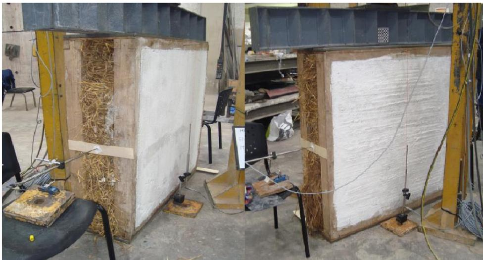
Según la norma NTE INEN 3153 “Ensayo de compresión de muretes” y ASTM C1314 “Compressive Strength of Masonry Prisms” señalan que la relación entre  $h_p/tp$  (altura/ancho) del panel debe estar entre 1.5 a 5.0, para el caso de los paneles fabricados esta relación es igual a 3.43 y permite determinar el factor de corrección por esbeltez que se indica en la tabla 60.
