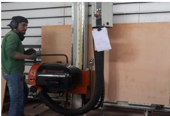
Se adquirieron tablones de 240 cm x 22.5 cm x 6 cm para fabricar las palancas principales y secundarias que forman parte del sistema a compresión, se decide utilizar los mismos debido a sus 6 cm de espesor que garantiza la resistencia de las palancas durante el prensado de la paja evitando que estas fallen. Los tablones son de laurel, este tipo de madera se puede encontrar fácilmente en nuestro medio, además de contar con propiedades
