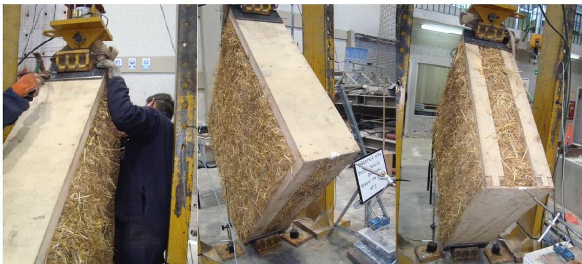
En la tabla 69 se muestra los esfuerzos máximos a corte de los tres paneles compuestos por marcos de madera y fardos de paja.
