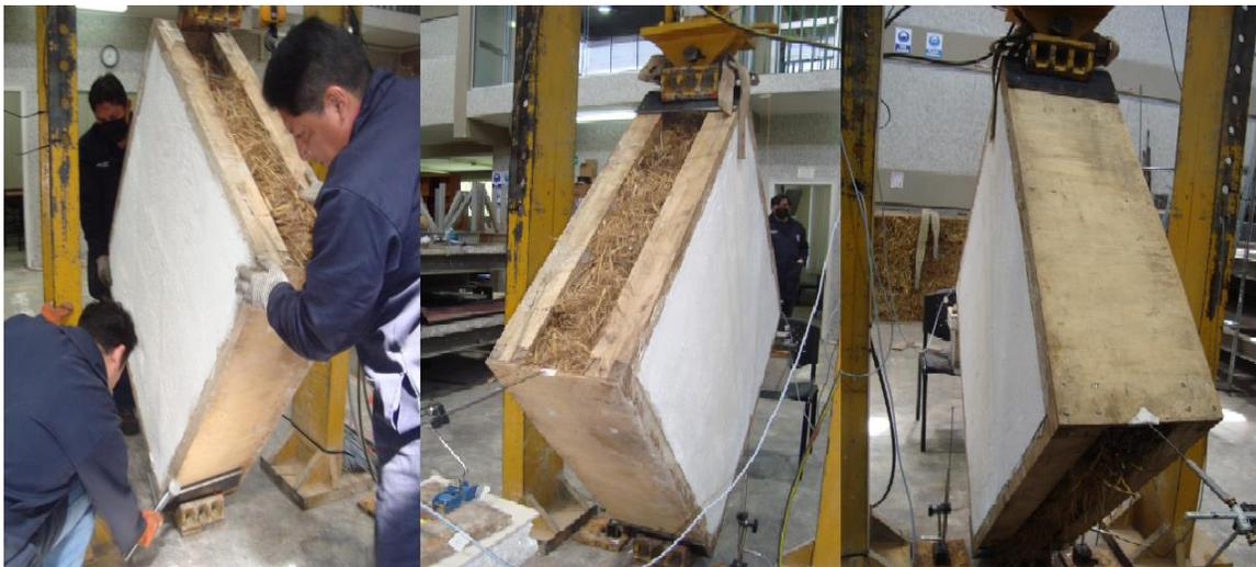
En la tabla 63 se muestra los esfuerzos máximos a corte de los tres paneles compuestos por marcos de madera, fardos de paja y recubrimiento a base de cal.
