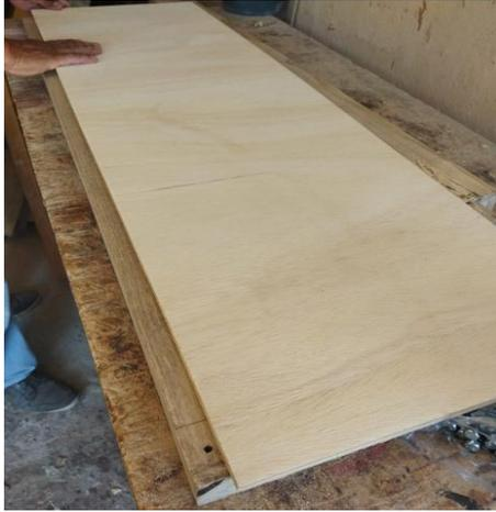
Las tapas superiores e inferiores de los paneles a estudiarse en esta investigación se fabrican a partir de planchas de tableros contrachapados que se distribuyen en el medio local con medidas de 122 cm x 244 cm x 1.2 cm. Para la obtención de estos elementos, las planchas se deberán cortar en piezas de 120 cm x 35 cm x 120 cm.
