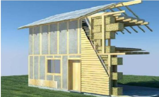
Sistema con Paneles prefabricados
