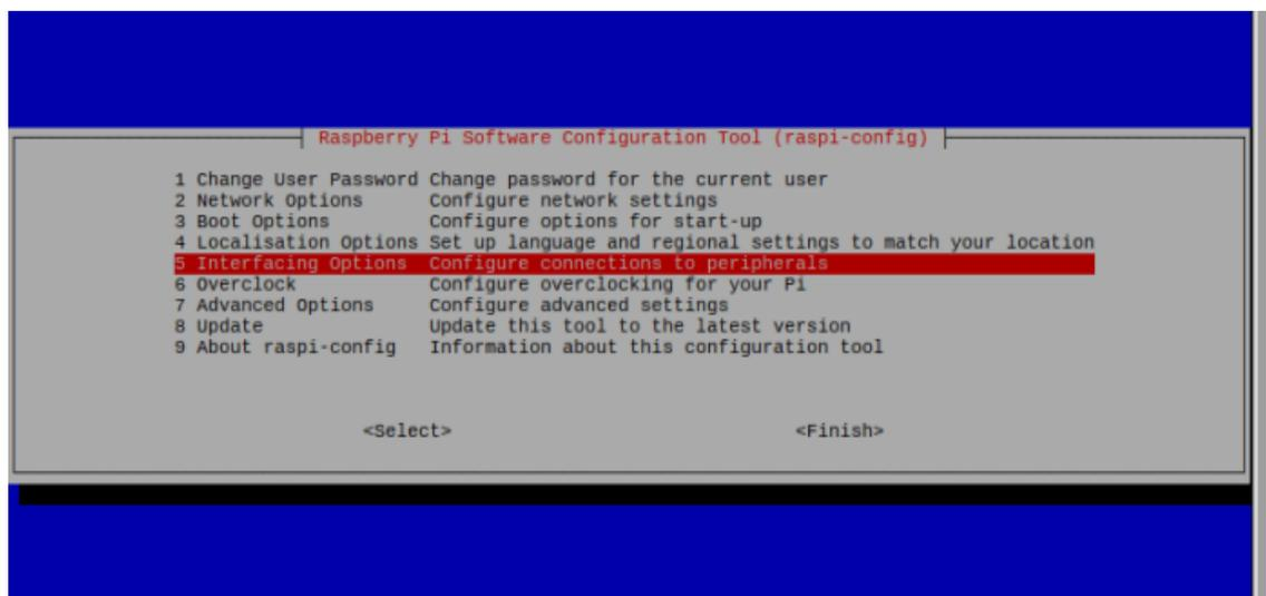
Dentro de la pantalla de **Interfacing Options**, se selecciona la opción P6 Serial, la cual, hace referencia a la habilitación del puerto serial, seguido de esto se despliega la pantalla que se muestra en la Figura 47, para aceptar la configuración del puerto, una vez aceptado se reinicia el dispositivo Raspberry, para que los cambios realizados se guarden y se ejecuten adecuadamente.
