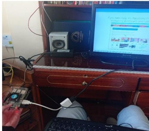
Una vez que se tiene el sistema operativo instalado y funcionando correctamente, se estableció una conexión con el puerto serial, para realizar dicha conexión primero hay que ejecutar el componente de configuración del Raspberry con el siguiente comando **sudo raspi-config**, al introducir este código se despliega la Figura 46, en la cual, se selecciona la opción de **Interfacing Options**.
