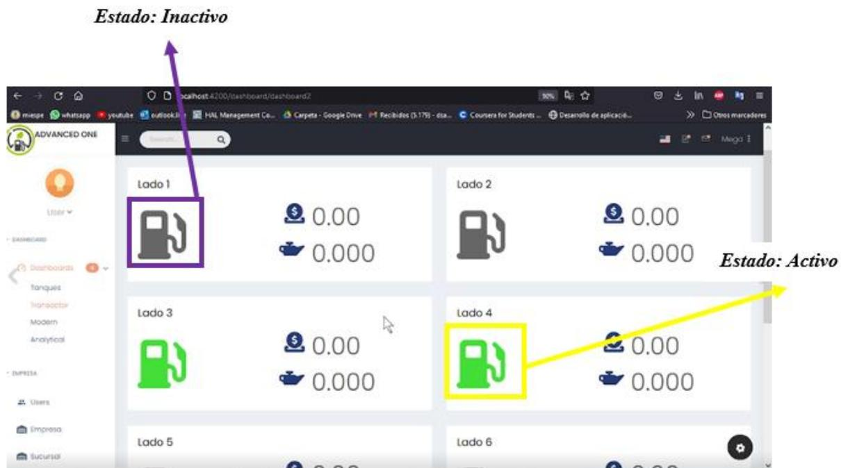
En la Figura 62, se puede observar cómo cambia el color del surtidor dependiendo el estado del simulador, en este caso ya se encuentra vendiendo, por lo cual, se puede observar los galones y el precio de la venta en tiempo real. Cabe recalcar que todo el proceso que se visualiza en la aplicación web está determinado por la aplicación de escritorio que es la que está procesando al momento la información enviada por el dispositivo.
