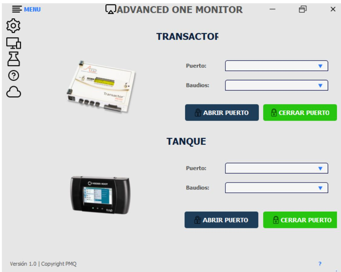
Una vez ejecutada la aplicación de escritorio, el software detecta si alguno de los dos dispositivos se encuentra conectado mediante el puerto serial, e identifica los baudios establecidos, para su correcta comunicación, permitiendo un enlace tanto para la recepción de datos como para el envío de comandos, la conexión se establece mediante el puerto y los baudios seleccionados. A continuación, se observa la Figura 55.
