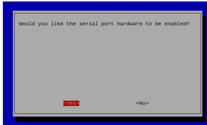
Para probar que el puerto serial del dispositivo Raspberry Pi, este abierto correctamente y que exista una conexión satisfactoria se crea una pequeña rutina de programación en cualquier lenguaje, en este caso Python para verificar que existe una respuesta exitosa. A continuación, en la Figura 48, se indica un ejemplo de codificación, para la verificación de que el puerto serial esté conectado correctamente.
