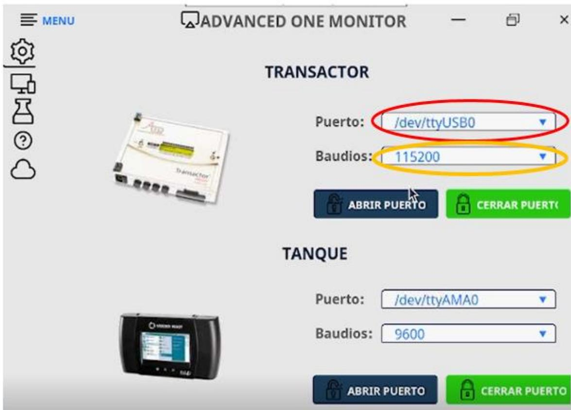
El siguiente paso para establecer la comunicación entre el mecanismo, y el software alojado en el Raspberry es abrir el puerto del elemento el cual se requiera usar, si los datos identificados tanto del puerto serial como la de los baudios son correctos, la aplicación arroja un mensaje de éxito indicando la información la cual se está usando del dispositivo para comenzar con la interacción, en la Figura 56, se visualiza el proceso mencionado anteriormente.
