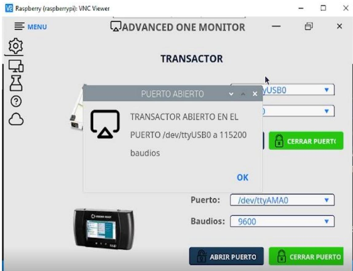
Para comprobar el funcionamiento correcto de la aplicación, en la consola del IDE de desarrollo, se enviaron mensajes de la información que se está recibiendo del dispositivo en este caso del Transactor, los datos llegan de forma poco manejable y por medio del software se la procesa en formato JSON, para que sea más entendible y su gestión sea mucho más sencilla. A continuación, en la Figura 57, se visualiza la impresión de los datos en tiempo real.
