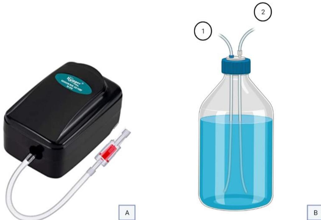
*Nota:* Esquema de fermentador A: Motores de pecera (Power Tm 500); B: 1: Conexión con el motor de pecera (Power Tm 500), mecanismo dual de aireación y agitación; 2: salida de aire.
