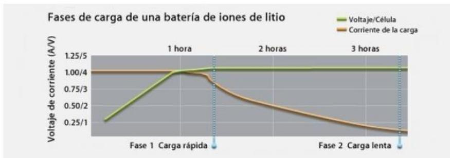
*Nota.* La figura representa las fases de carga de las baterías de iones Litio. Tomado de *¿Como cargar la batería de tu móvil correctamente?* por Juan Cascón Baños, Frikipandi
