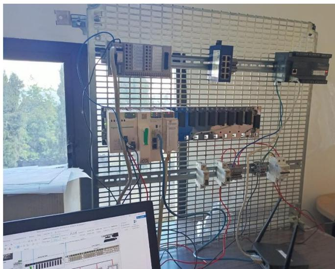
Las pruebas FAT se realizaron en las instalaciones de la empresa SEIUS S.A. como se muestra en la Figura 106, donde se montó los equipos en el laboratorio. En primer lugar, se realizó una inspección visual sobre el estado de los equipos, verificación de códigos de series, entre otros. En la Tabla 10 se resumen los criterios de aceptación en las pruebas FAT, estos fueron establecidos por parte de la empresa IANCEM, bajo los siguientes parámetros:
