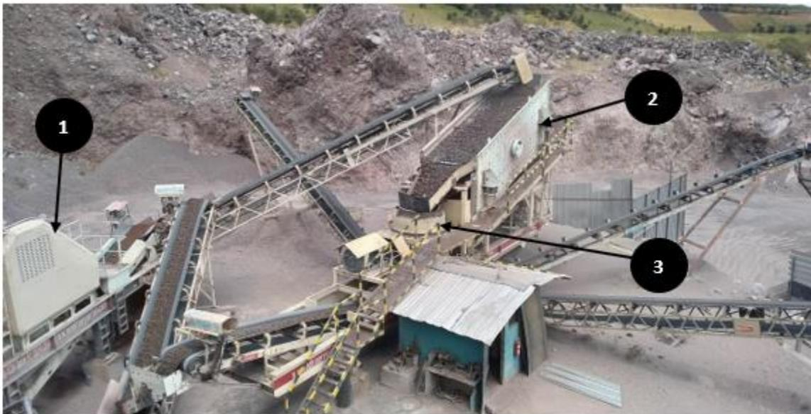
*Nota.* 1: trituradora de mandíbula, corresponde a la primera fase de trituración. 2: zaranda vibratoria. 3: trituradora de cono. Además, se puede apreciar las bandas transportadoras.
