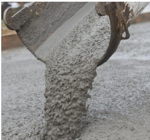
*Nota.* Imagen ilustrativa del hormigón en donde se puede apreciar el agregado grueso , tomado de (GCP Applied Technologies, 2021).
