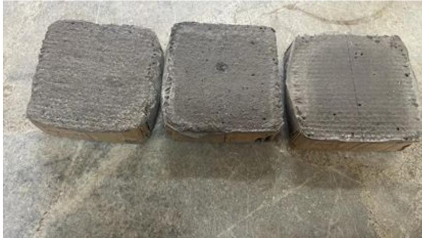
Probetas utilizando cartón prensado
