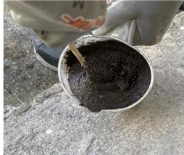
Desenfofrado de probetas de adoquín con resina
