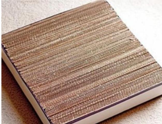
Con su estructura corrugada de canaletas y crestas, permite que el material sea más resistente a la flexión y la compresión
