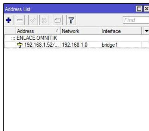
*Nota.* Al igual que Ap en el Cpe se debe configurar la Ip siempre manteniendo el rango de Ip y seleccionamos en modo Bridge
