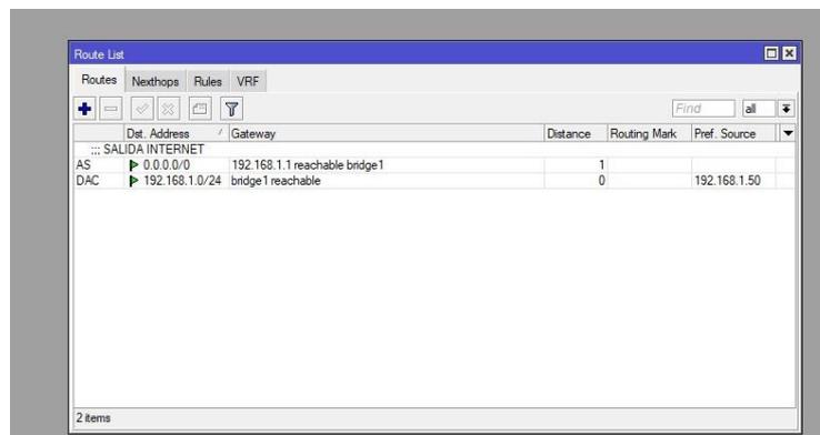
*Nota.* Se procede a configurar la puerta de enlace para la conexión entre AP y CPe en el rango de IP 192.168.1.0 se cambia el modo a Bridge.
