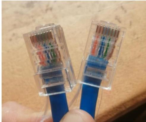
*Nota.* La figura representa el ponchado de cable para las conexiones entre antenas y cámaras, el tipo de cable que se utiliza es el cable UTP Cat 6 que se puede transmitir datos a velocidades de hasta 1 Gbps.
