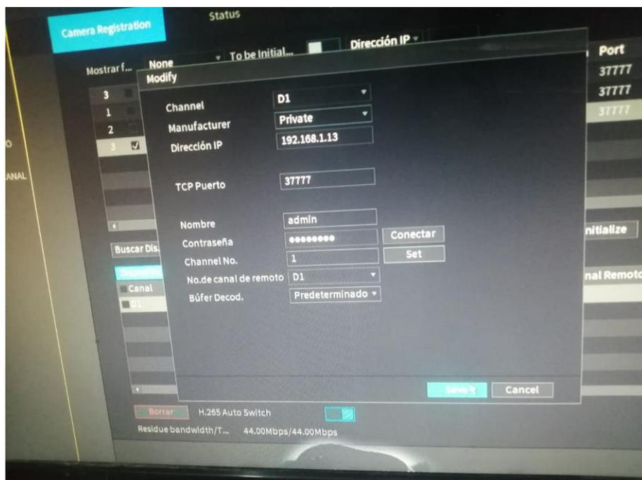
*Nota.* Se procede a la colocación de las direcciones IPs en cada una de las cámaras, se escribe el usuario y contraseña que eso se configuro en el NVR esto servirá para guardar los cambios.
