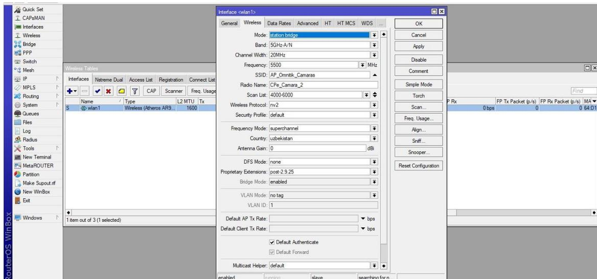
*Nota.* En esta figura lo primero que se procede hacer es activar el modo bridge, cambiar la frecuencia, se escanea al Ap para poder enlazarle con el CPe, colocamos el SSID al CPe, aplicamos y guardamos los cambios.
