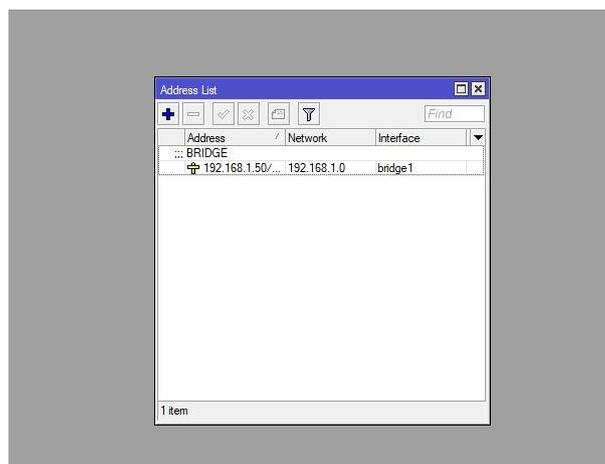
*Nota.* Se procede a cambiar la IP que viene por defecto a la 192.168.1.50 (esta es el rango de IP que se va a trabajar) al momento que se cambia IP, también se modifica en modo de operación a Bridge.
