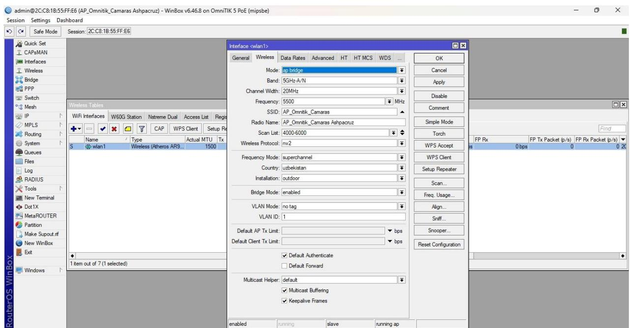
*Nota.* En esta sección se procede a configurar las frecuencias de la AP, el SSID, la ciudad etc. Adicional también se configura en modo bridge.
