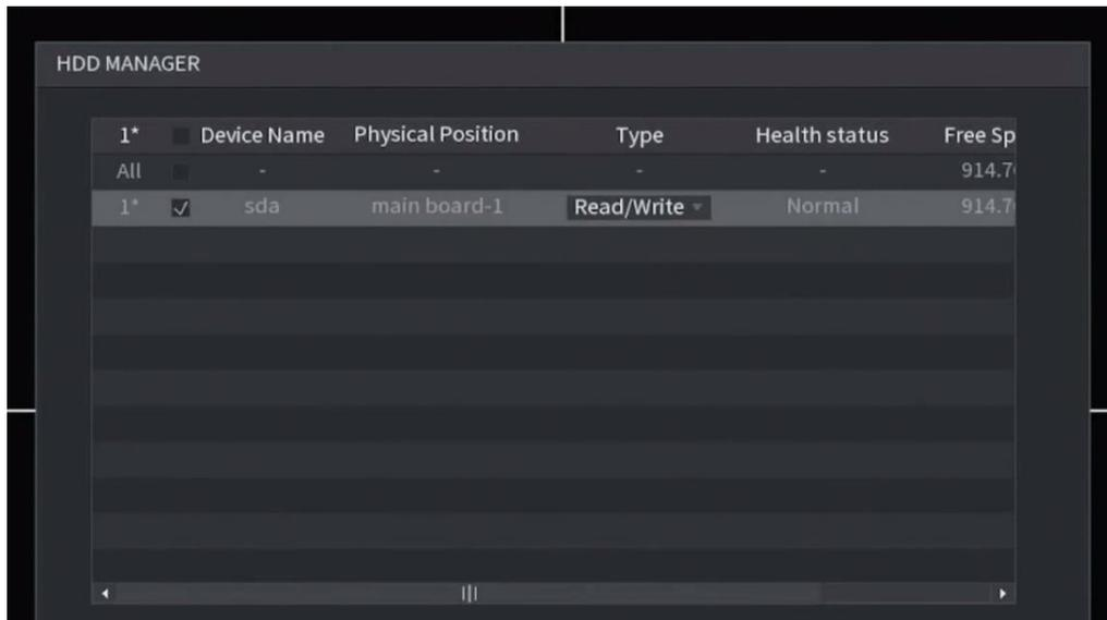
*Nota.* Se configura los permisos del disco duro del grabador en el NVR. Tomado de Dahua Technology Iberia [@DahuaTechnologyIberia]. (2021, julio 28). IMOU – NVR.
