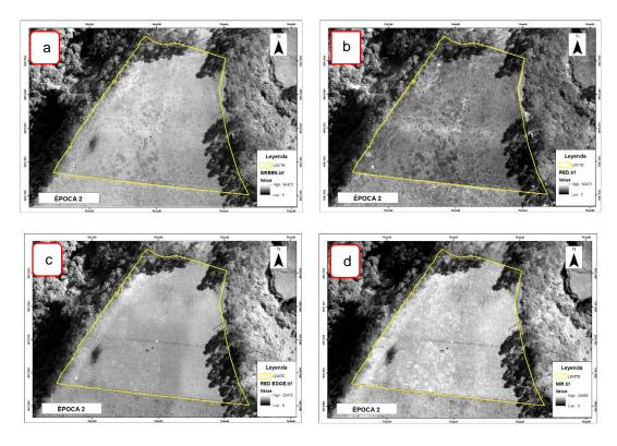
Nota: En el gráfico se muestran los ortomosaicos multiespectrales de las bandas: a: Green, b: Red, c: Red Edge, d: NIR, del 22 de junio del 2023, en el sistema WGS84, coordenadas proyectadas UTM 17 S.
