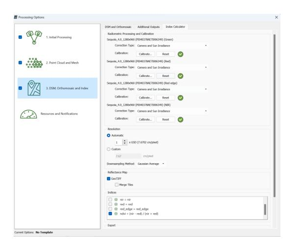
En la calibración, se cargaron las imágenes capturadas durante la calibración radiométrica en campo (Ver Figura 18), explicada en el apartado Planificación del vuelo fotogramétrico.
