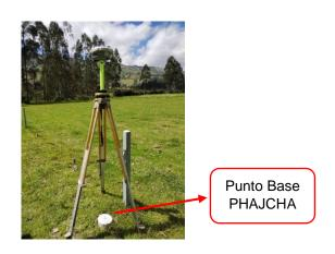
El procesamiento del punto estático se lo realizó en el programa *Timble Bussines*Center; se utilizó como referencia la estación EPEC correspondiente al día 8 de marzo del 2023, las precisiones registradas se pueden observar en la Tabla 1.
