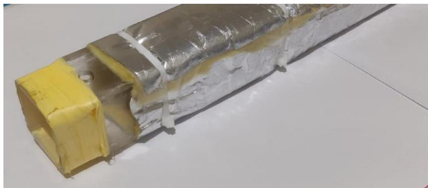
*Nota.* La figura muestra el canal de acrílico cuyas paredes fueron forradas con lana de vidrio ayudándose de bridas plásticas y con teflón en su extremo para un acople hermético con la pieza central de la plataforma.
