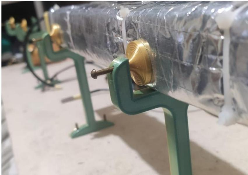
*Nota.* La figura muestra una fotografía de los soportes para canales con regulación de fijación con el uso de tornillos. El diseño está pensado para brindar el espacio suficiente para la medición de velocidad de fluido con el anemómetro además de abrir la posibilidad a utilizar diferentes generadores de flujo mucho más potentes cuya salida generalmente se ubica a una distancia significativa con respecto al nivel del suelo. Los planos mecánicos se encuentran en el apéndice A.
