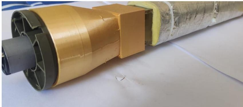
Nota. La figura muestra el acople del ventilador con el canal de entrada permitiendo la generación del flujo.
