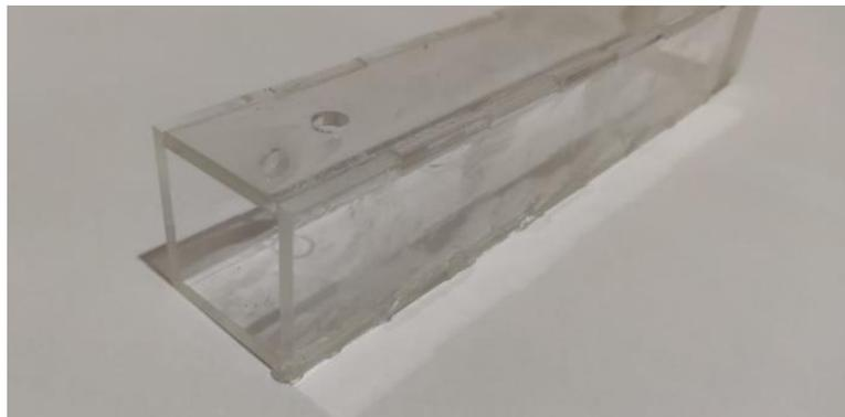
*Nota.* La figura muestra la construcción y ensamble del canal el cual se compone de sus cuatro aristas unidas con pegamento acrílico y silicona de uso general entre sus uniones.
