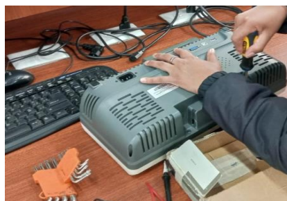
Desmontaje del osciloscopio “OWON1LEDESPE”
