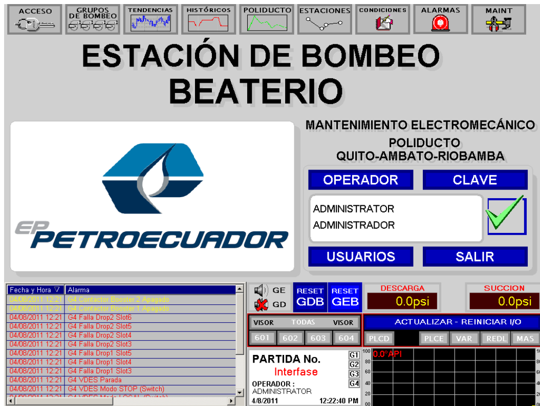
Figura 5.7. Paneles de Proceso: Acceso
