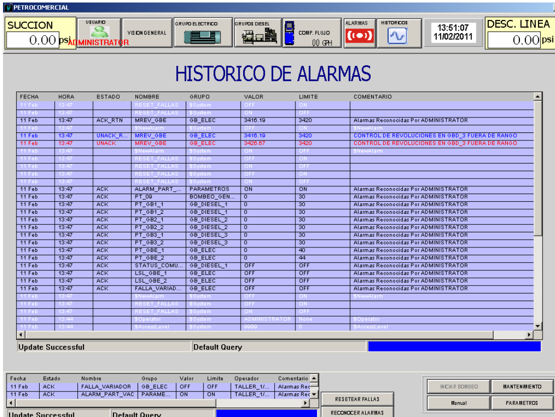
Figura 3.31. Ventana de Alarmas
