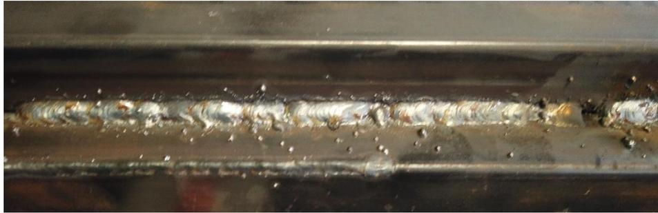
*Nota.* Cordón de soldadura realizado a una tensión de 11,5 V y una corriente de 90 A.
