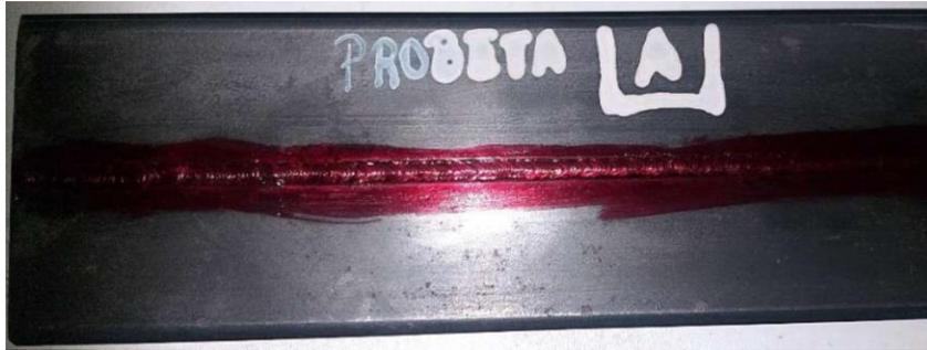
*Nota.* Aplicación de líquidos penetrantes con un tiempo de penetración de 15 minutos.
