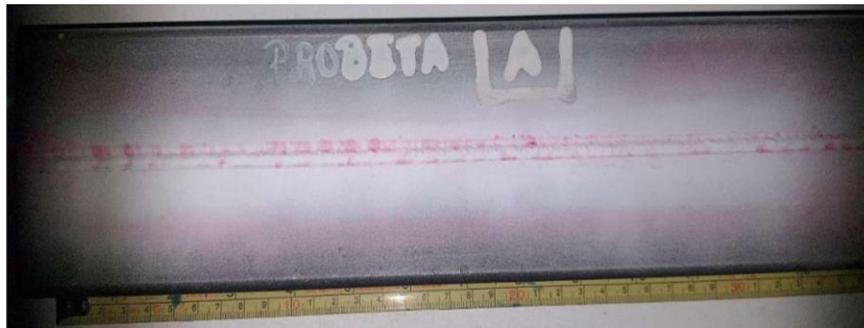
*Nota.* Aplicación del revelador con un tiempo de revelado de 10 minutos. Tomado de (Velastegui, 2023).
