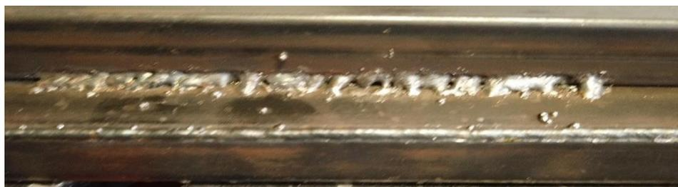
*Nota.* Cordón de soldadura realizado a una tensión de 10 V y corriente de 60 A.
