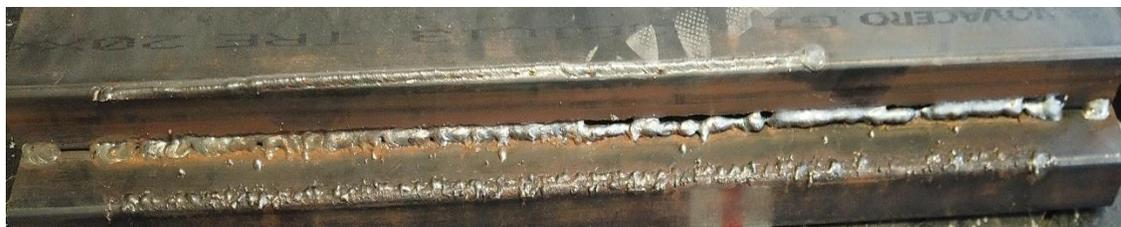
*Nota.* Cordón de soldadura realizado a una tensión de 17,9 V y corriente de 111 A.
