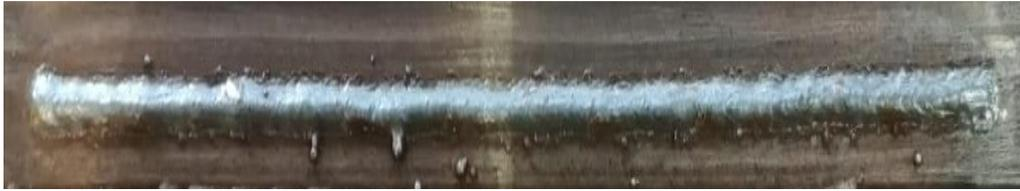
*Nota.* Cordón de soldadura realizado a una tensión de 17,9 V y una corriente de 111 A.
