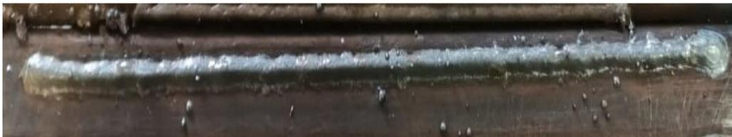
*Nota.* Cordón de soldadura con bordes rojizos realizado con una tensión de 17 V y una corriente de 100 A.
