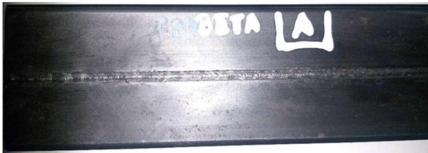
*Nota.* Preparación de la probeta a base de solvente SKC-S/MAGNAFLUX. Tomado de (Velastegui, 2023).
