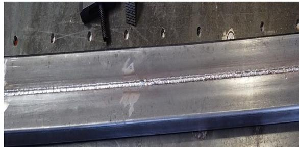
*Nota.* Cordón de soldadura realizado a una tensión de 17,9 V y corriente de 111 A.
