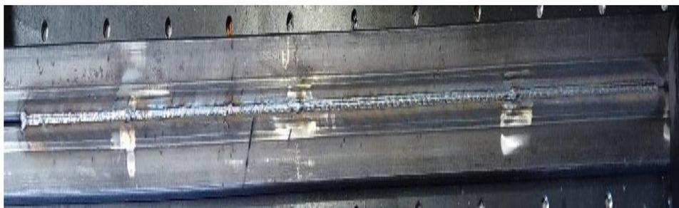
*Nota.* Cordón de soldadura realizado a una tensión de 17,9 V y una corriente de 111 A.
