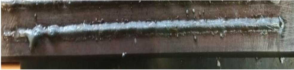
*Nota.* Cordón de soldadura realizado a una tensión de 16 V y una corriente de 98 A.
