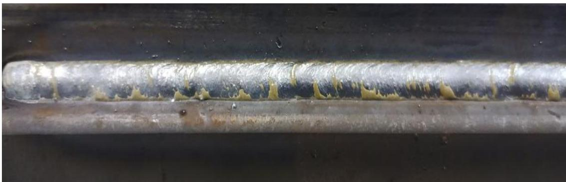
*Nota.* Cordón de soldadura realizado a una tensión de 16,7 V y un corriente de 89 A.
