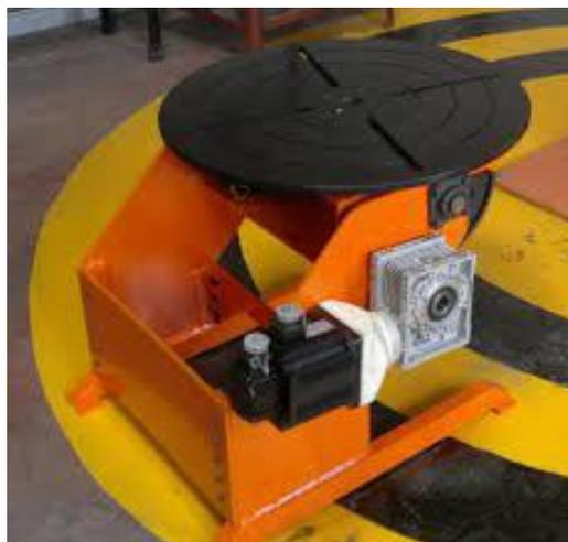
*Nota.* Mesa posicionadora disponible en el Laboratorio de Robótica Industrial. Tomado de (Arias y Toapanta, 2013).
