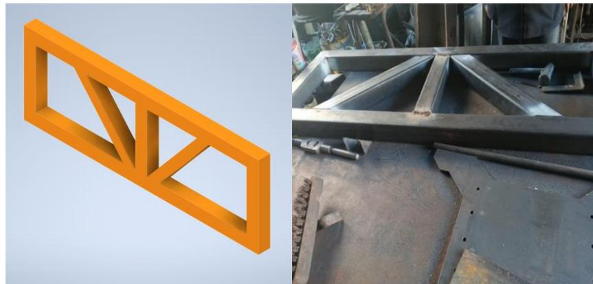
*Nota.* En la figura izquierda se observa el soporte lateral diseñado en software CAD/CAE y en la figura derecha en su aspecto físico.
