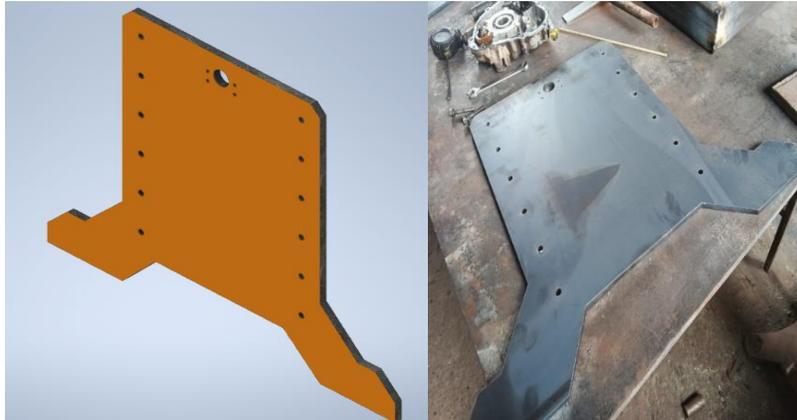
*Nota.* En la figura izquierda se observa la pared principal diseñada en software CAD/CAE y en la figura derecha en su aspecto físico.
