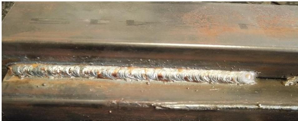
*Nota.* Cordón de soldadura realizado a una tensión de 16 V y corriente de 77 A.
