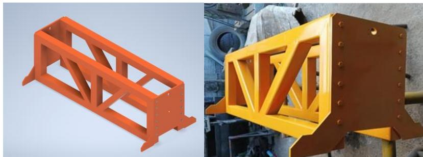
*Nota.* En la figura izquierda se observa el ensamble de la estructura principal diseñado en software CAD/CAE y en la figura derecha en su aspecto físico.
