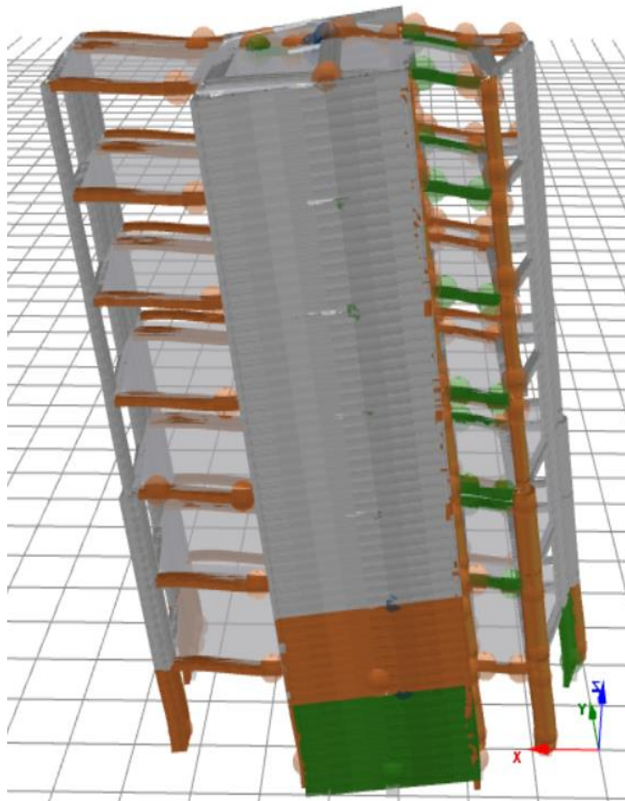
Deformada sentido "X" Edificio 1
