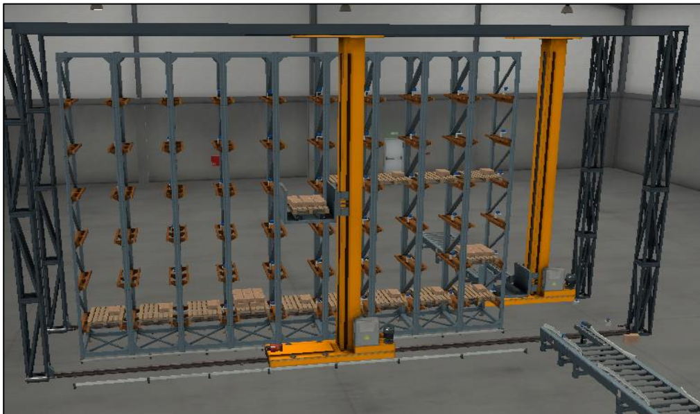
Detalle de sistema de almacenamiento automático
