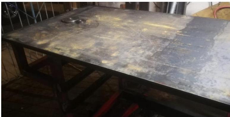
La mesa de trabajo, la cual está fabricada de una plancha de acero, cuenta con un sistema de nivelación vertical para generar biseles en los codos de los tubos de ventilación de acuerdo a las necesidades del cliente.
