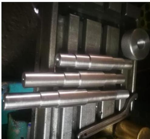
Los ejes fueron torneados a partir del diseño establecido para el ensamblaje del sistema de biselado de codos para tubos de ventilación.
