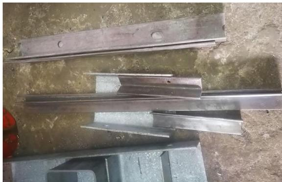
Después del proceso de corte, cada pieza pasa por una etapa de esmerilado para eliminar las escorias y rebabas dejadas por la acción del plasma, manteniendo por supuesto todas las protecciones industriales de la estructura.
