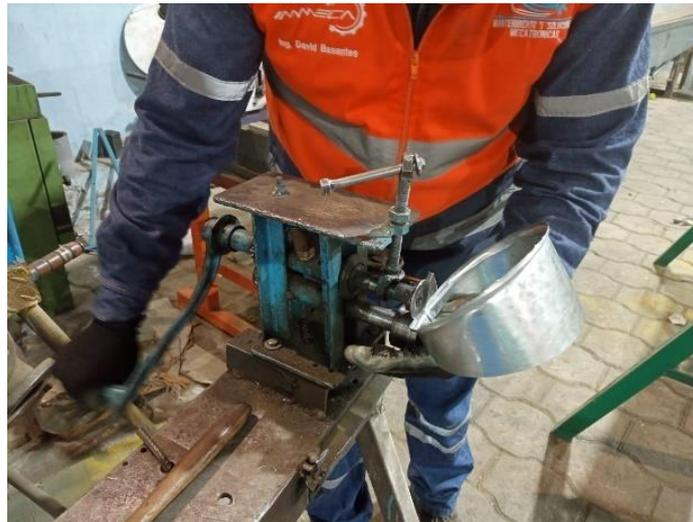
El segundo proceso consta del sellado de los biseles mediante una serie de golpes con el martillo.
