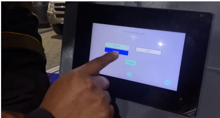
Para empezar con el proceso de elaboración se procede a realizar el biselado, el tubo debe ubicarse en la mesa de trabajo y para empezar el panel de control mostrará los pasos para escoger el proceso, en este caso será el tipo de tubo, el espesor y el ángulo. Luego se mostrará la opción iniciar al pulsar el botón de inicio.
