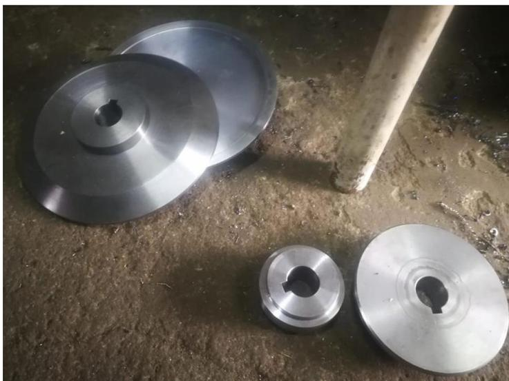
Platos de acero que van ensamblados junto al mecanismo de accionamiento, mismo que son mecanizados mediante la técnica de torneado. Los platos angulares permiten el pulido del biselado en los codos.
