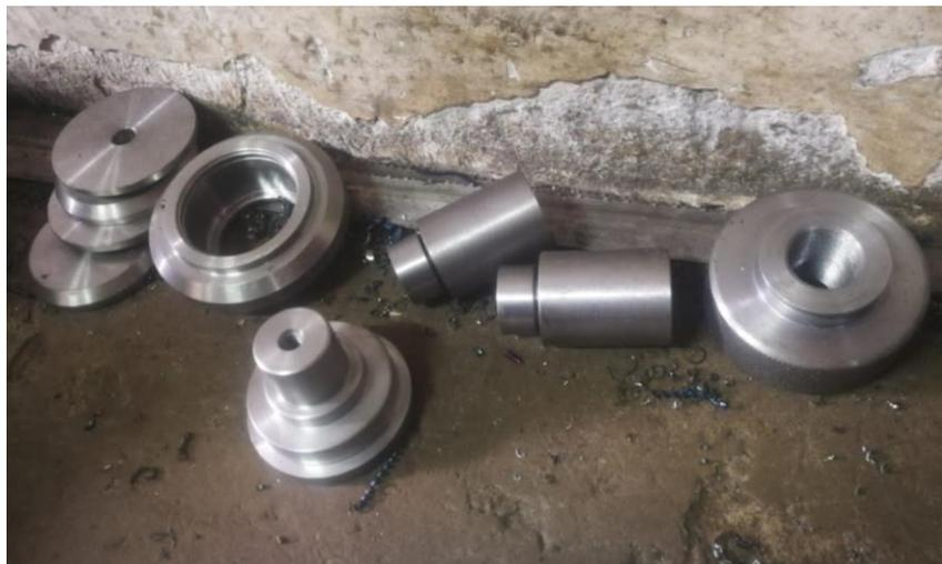
Mecanizado de las ruedas de acero que permitan la transmisión de movimiento en el sistema de biselado.
