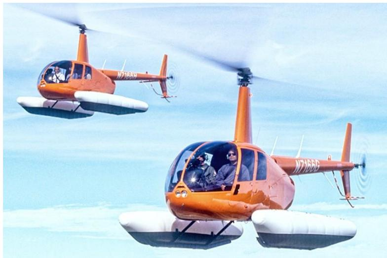
*Nota.* El helicóptero CLIPPER I cuenta con flotadores utilitarios fijos que proporcionan una medida adicional de seguridad durante las operaciones realizadas sobre el agua. Tomado de (HELICOPTER, 2022)
