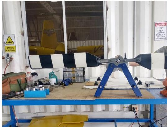
*Nota.* Rotor calibrado de manera horizontal como lo indica el manual de mantenimiento en el capítulo 30, sección 30-11 parte B
