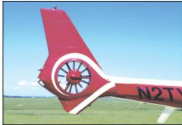
*Nota.* En comparación con un rotor de cola sin protección, el sistema antitorque fenestrón proporciona un margen mejorado de seguridad durante las operaciones en tierra. Tomado de (FAA, 2000)
