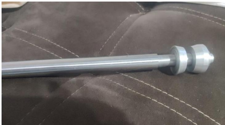
*Nota.* Los adaptadores son las dos piezas que sobresalen en la forma del eje estas encajan perfectamente en el eje del rotor de cola y aseguran de que no se salga o forme vibraciones al realizar el proceso de balance.
