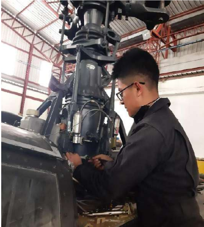
Inspección de la plataforma de soporte de la main gear box
