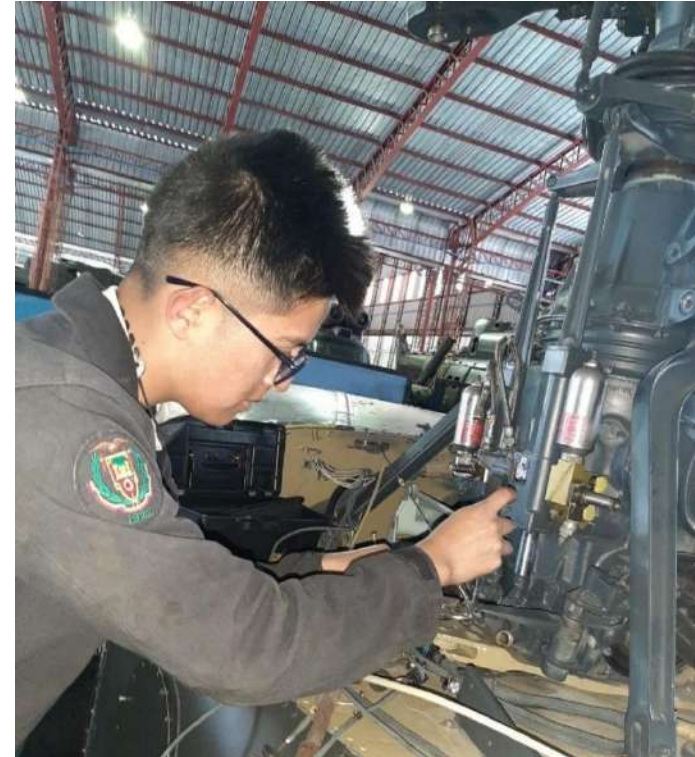
Verificación del espacio entre la MGB y el "Hydraulic Power Pack"
