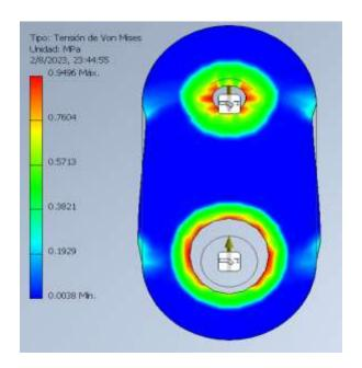
En la figura 41 se muestra el análisis estático al aplicar una fuerza de 63.02 N al modelado, donde el valor máximo critico es de 0,4372 MPa el mismo que se encuentra dentro del límite elástico que es de 35-40 MPa.
