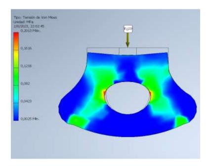
En la figura 44 se muestra el análisis estático al aplicar una fuerza de 67.72N al modelado, donde el valor máximo critico es de 0.20 MPa el mismo que se encuentra dentro del límite elástico que es de 35-40 MPa.
