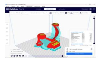
Una de las ventajas de utilizar el software de impresión 3D Cura es conocer el tiempo de impresión, cantidad de material que será utilizado en la impresión y simular su proceso de impresión.
