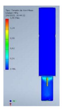
En la figura 43 se muestra el análisis estático al aplicar una fuerza de 67.28 N al modelado, donde el valor máximo critico es de 1.55 MPa el mismo que se encuentra dentro del límite elástico que es de 35-40 MPa.
