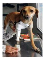
En la vista lateral derecha se puede apreciar el mecanismo de articulación en el cual se verifica y procede a revisar el resorte dimensionado para dar movilidad a dicha articulación se mantenga rígido durante la caminata del perro caso contrario de no ser así se volvería a dimensionar otro resorte garantizando así la seguridad del can a la hora de movilizarse de un punto A un punto B.
