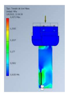
En la figura 42 se muestra el análisis estático al aplicar una fuerza de 65.91 N al modelado, donde el valor máximo critico es de 0,4372 MPa el mismo que se encuentra dentro del límite elástico que es de 35-40 MPa.
