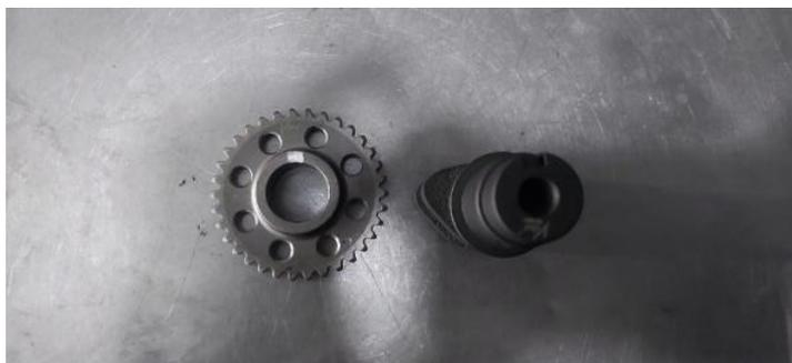
*Nota.* Se muestra el piñón de sincronización y la marca para el árbol de levas de alto rendimiento
