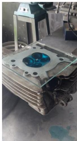
*Nota.* Se muestra la medición del volumen de la cámara de combustión a través del uso del líquido trazador
