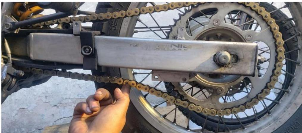
*Nota.* Se muestra la regulación del sistema de transmisión del kit de arrastre de alto rendimiento
