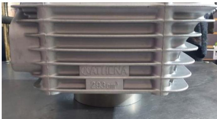
*Nota.* Se muestra el cilindraje especificado por el fabricante
