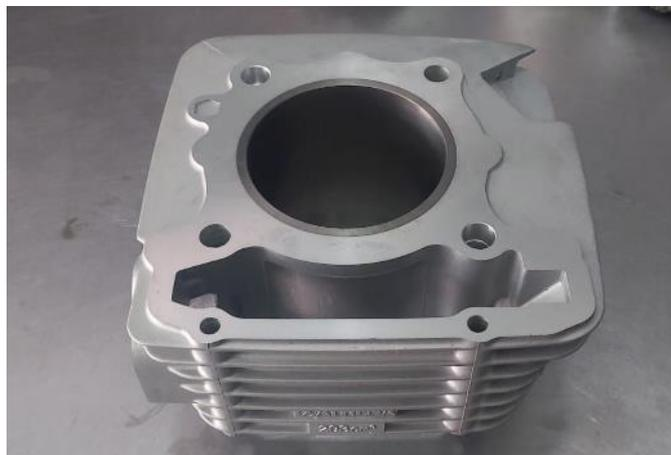
*Nota.* Se muestra el cilindro modificado que forma parte del kit de alto rendimiento
