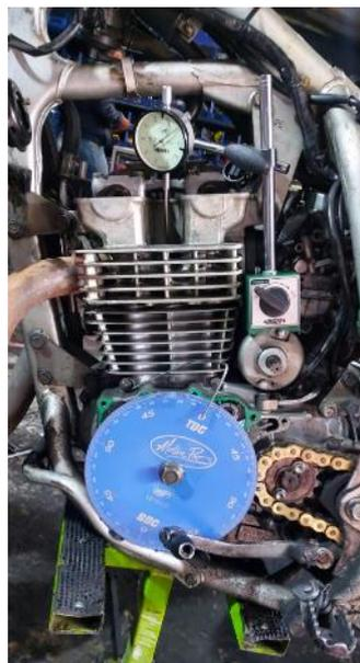
*Nota.* Se muestra la identificación el punto de sincronización del motor
