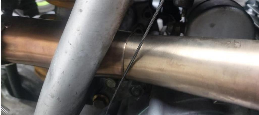
*Nota.* Se muestra la junta de la curva de escape y el silenciador
