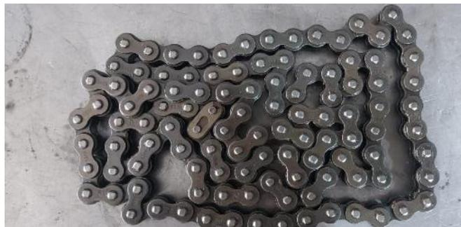
*Nota.* Se muestra la cadena que se va a emplear en el sistema de transmisión.
