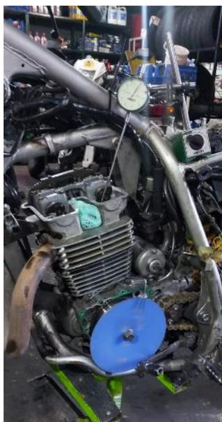
*Nota.* Se muestra la medición de los ángulos de válvulas empleando el reloj palpador
