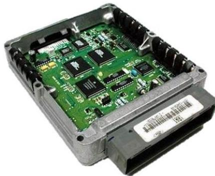
*Nota.* En la figura se observa la composición física de la PCM. Tomado de (Donado, 2022).
