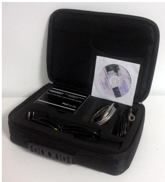
*Nota.* En la figura se puede apreciar el equipo FADOS9F1 utilizado para realizar el test de imágenes de los componentes electrónicos del subsistema de control electrónico.
