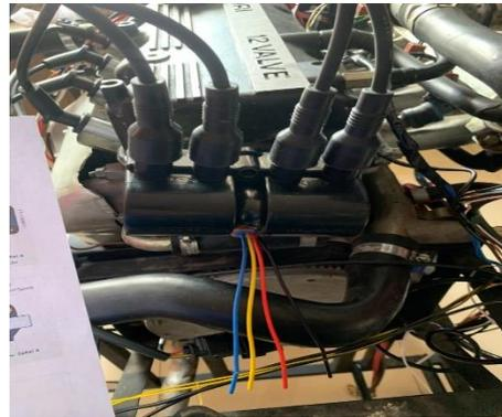
Instalación del sensor IAT, TPS, etc. Para la instalación se debe señalar los cables de acuerdo con lo menciona en el diagrama del manual para la parte eléctrica.
