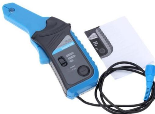
*Nota.* En la figura se puede apreciar la Pinza Amperimétrica, la cual se utilizó para realizar medición de intensidad de los componentes eléctricos del motor
