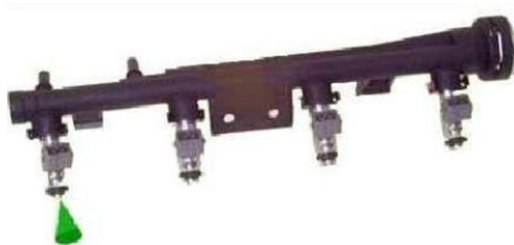
*Nota.* En la figura se muestra como el inyector realiza la pulverización de combustible de forma secuencial. Tomado de (Castro, 2013).
