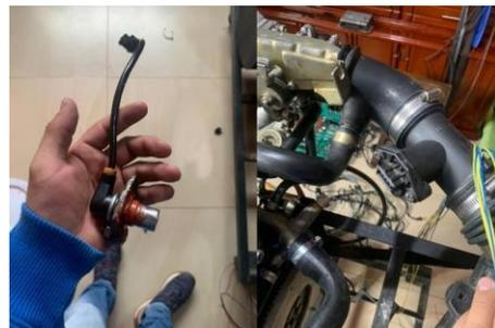
Instalación del circuito eléctrico nuevo (arnés que proporciona ECU RaceTec), es importante determinar la ubicación por donde el cable debe ir, ya que si se encuentra en lugares de alta temperatura se quema el cable y puede causar cortocircuitos.
