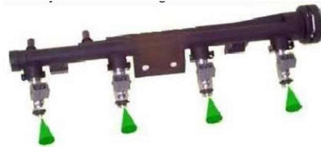
*Nota.* En la figura se observa cómo se realiza la pulverización de todos los inyectores al mismo tiempo.
