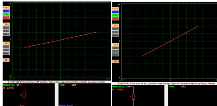
*Nota.* En la figura se muestra la figura de Lissajous del sensor TPS
