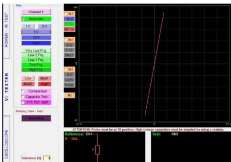
*Nota.* En la figura se puede apreciar la figura de Lissajous de una resistencia, en donde se muestra diferentes relaciones de frecuencias y desfases de las ondas.
