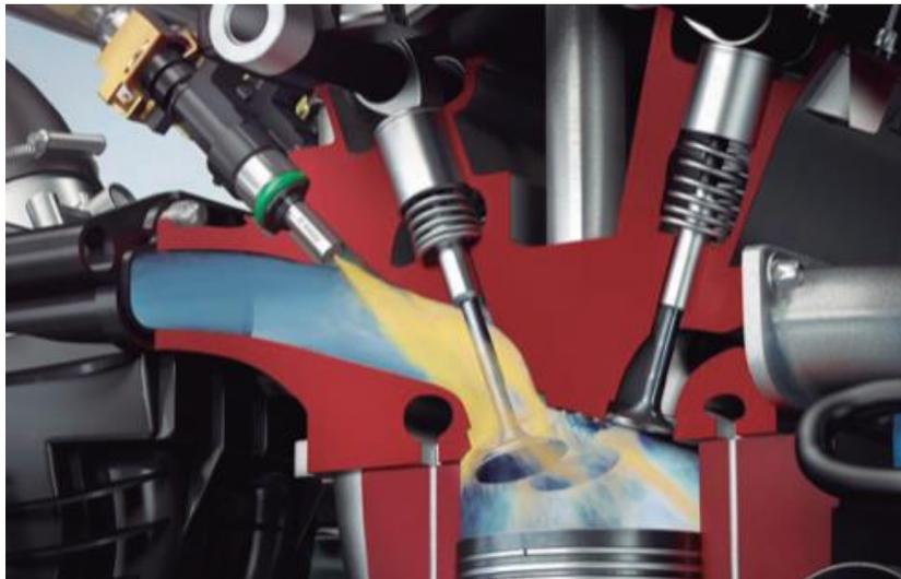
*Nota.* En la figura se muestra la posición del inyector, el mismo que se encuentra fuera de la cámara de combustión. Tomado de (Bosch, 2014).
