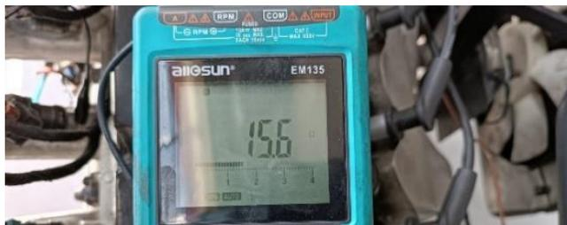
*Nota.* En la figura se observa la medida de resistencia del inyector tomada con el multímetro.
