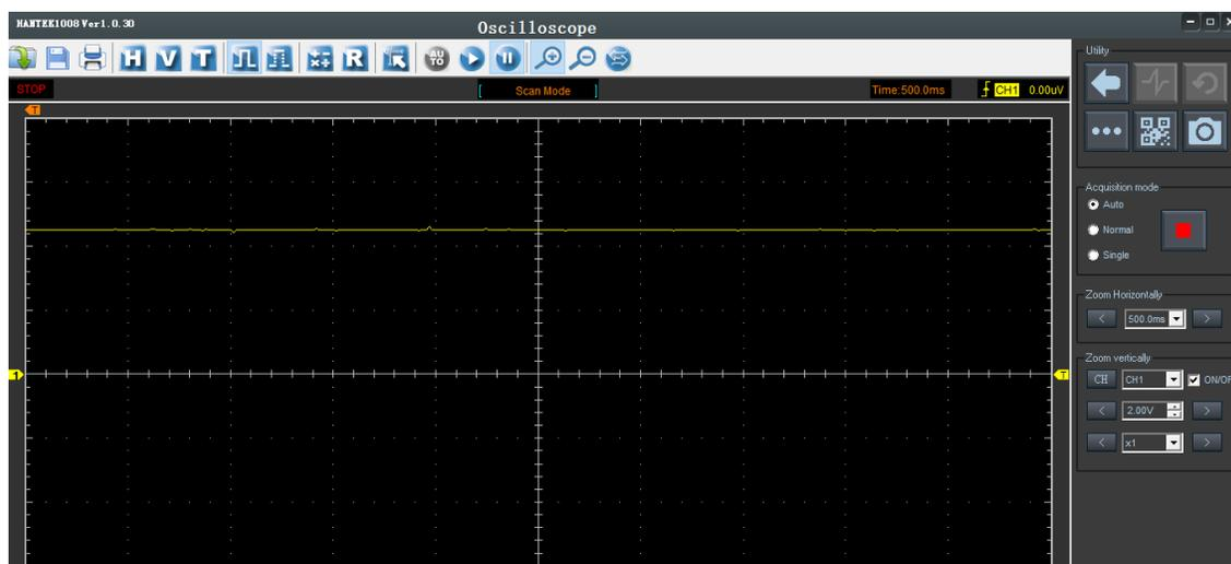
*Nota.* En la figura se observa el oscilograma del sensor TPS en ralentí.
