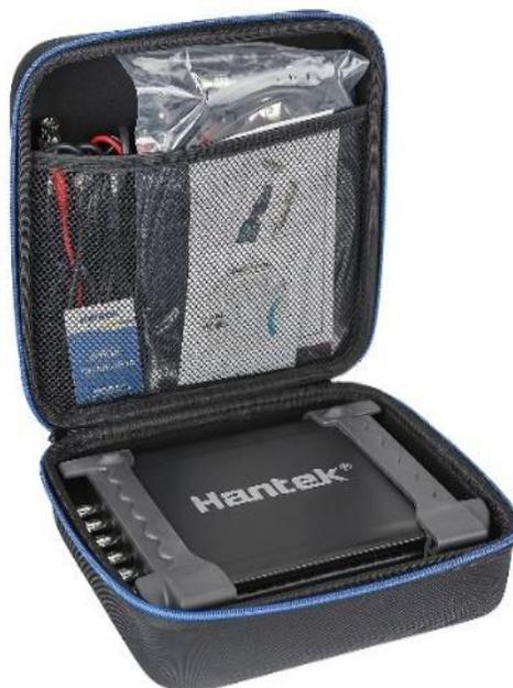
*Nota.* En la figura se puede apreciar el Osciloscopio Automotriz HANTEK 1008C de 8 canales utilizado para realizar el diagnóstico automotriz de los componentes electrónicos del subsistema de control electrónico.
