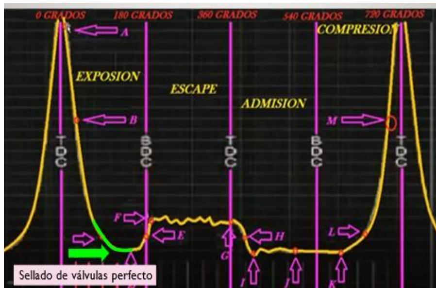
*Nota.* En la figura se observa la gráfica para comprobar que exista un sellado de válvulas perfecto.
