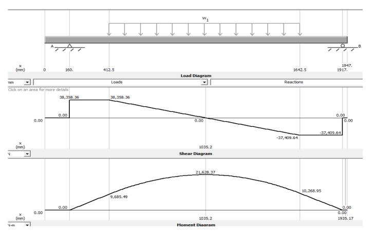
Mediante un análisis en el software MD Solid se determina las reacciones que se generan al aplicar la carga para rolar la lámina de acero.
