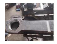
Base para motor hidráulico
