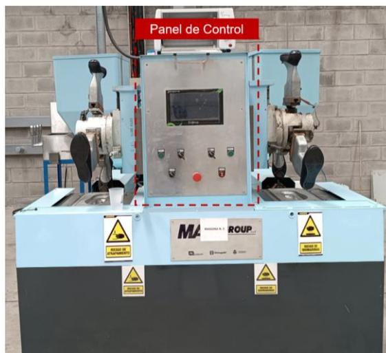
El panel ofrece al operario funciones esenciales para el control del proceso. En la Figura 61 se presentan los elementos del panel de control, que incorpora una interfaz con una pantalla táctil HMI, pulsadores, selectores y un buzzer, cuya funcionalidad se describe en la Tabla 74.
