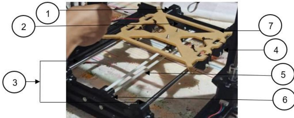
*Nota.* En la figura se puede observar los elementos del mecanismo del eje Y.
