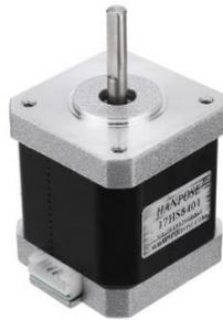
*Nota.* En la figura se puede observar el motor nema 17. Tomado de (Isaac, Nema 17, 2020).
