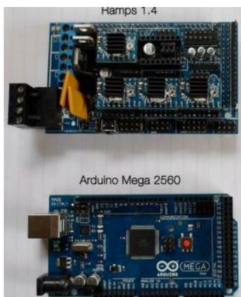
*Nota.* En la figura se puede la tarjeta Arduino Mega y Tarjeta Ramps. Tomado de (Carabali & Coral, 2016).
