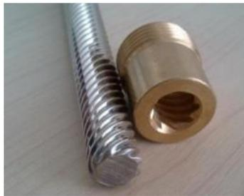
*Nota.* En la figura se puede observar el mecanismo de tornillo de avance – husillo. Tomado de (Leon & Torres, 2013).
