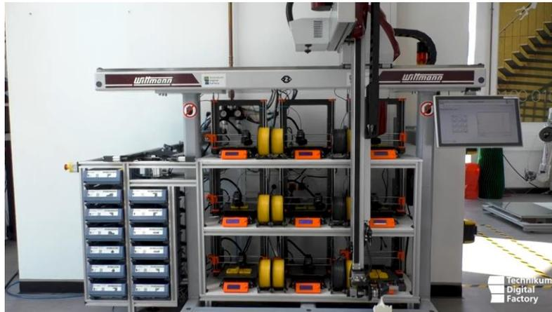
*Nota.* En la figura se observa una granja de impresoras 3D automatizada basada en robots.
