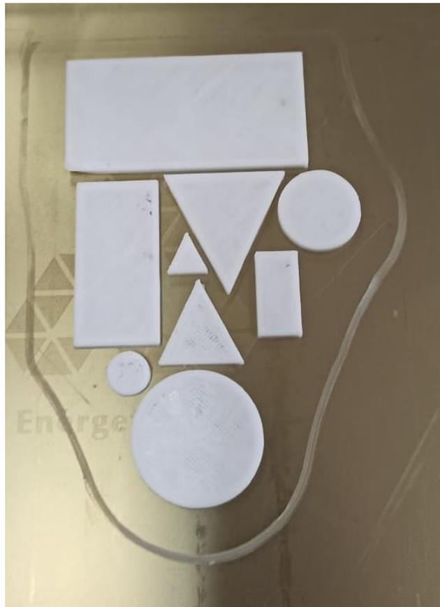
*Nota.* En la figura se puede observar los modelos de prueba de la impresora 3D.
