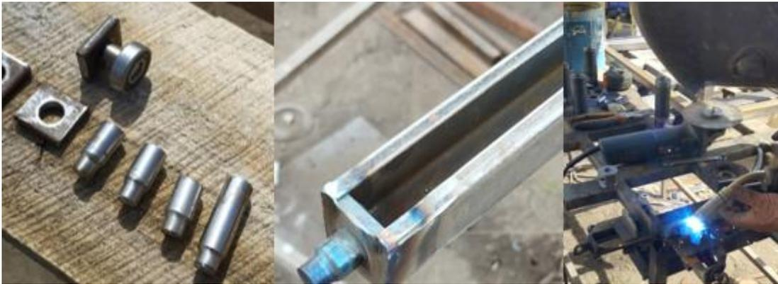
Continuando con la construcción se realizó el corte de ángulos para acoplar cilindro neumático con barra lateral y esmerilado.
