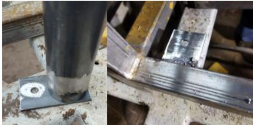
Luego se empernó la placa de soporte con placas base de cilindros neumáticos de barras laterales y se sujetó los cilindros a las barras laterales.
