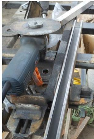
De igual manera se realizó el corte de un eje para luego proceder con el torneado de eje de acero para la barra lateral, este se soldó con el perfil previamente cortado y se acopló un rodamiento para el movimiento de la barra.
