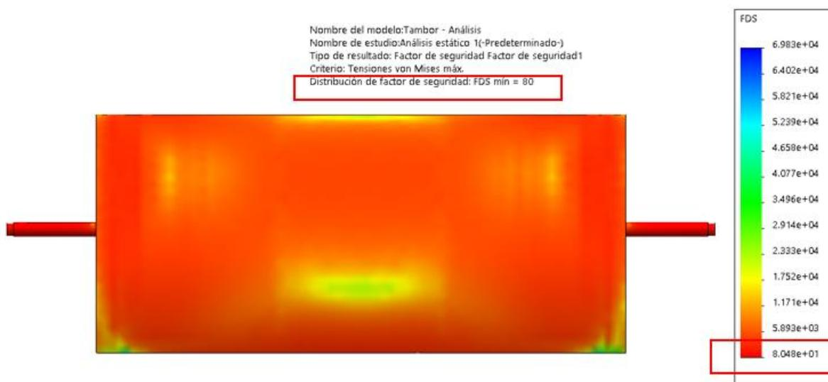
**Factor de Seguridad**, la Figura 86 muestra el FDS mínimo resultante aplicando el criterio de Tensión de Von Mises Máximo es de 80, el cual es aceptable, por lo que según la
