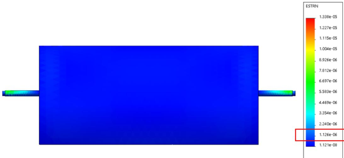
**Deformación Unitaria**, al igual que las Tensiones originadas son aceptables, en vista que se puede distinguir, que en la parte donde se genera mayor deformación unitaria, da un valor de 0.000001121, verificando el color azulado según la escala de colores, como se indica en la Figura 85.
