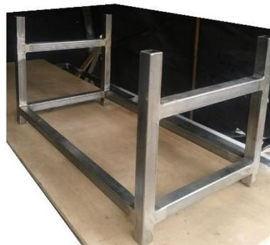
Se procedió con el corte de platinas y varilla cuadrada para placa corredera, realizando la unión por soldadura, finalmente retirando el exceso de soldadura mediante esmerilado.
