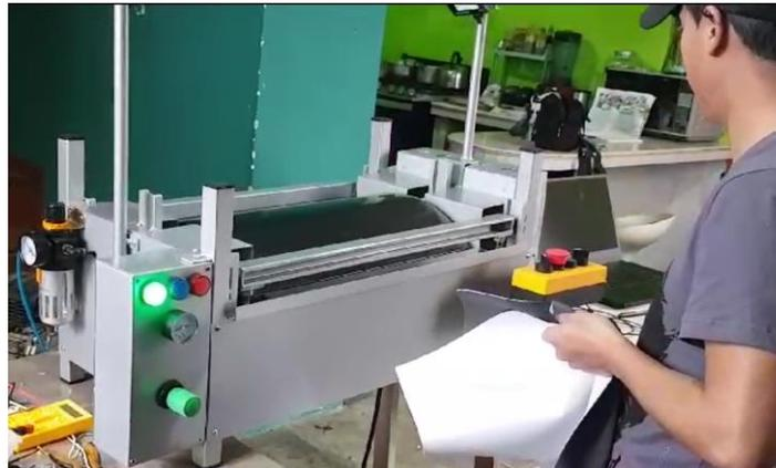
Para encender las lámparas según se requiera se utiliza el selector de dos posiciones, ubicado en el extremo derecho de la botonera.
