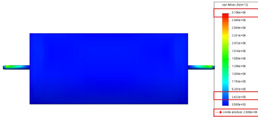
**Tensiones equivalentes** según el criterio de VON Mises, son consideradas aceptables, ya que se puede observar que la máxima resistencia que el tambor podría soportar es de 3.1 MPa, donde su resistencia máxima es de 250 MPa, visualizando que la mayor parte de la resistencia, del material está en 0.262 MPa, verificando el color azulado según la escala de colores, como indica la Figura 83.
