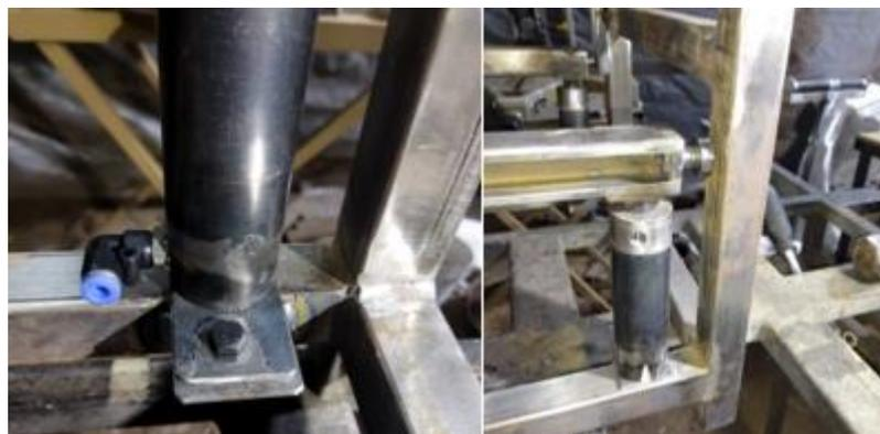
De igual manera se soldó las placas correderas en estructura mecánica, acoplando los cilindros neumáticos, barra lateral y placa corredera
