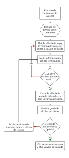
Nota. Se muestra el diagrama de flujo base del proceso que va a realizar el prototipo.
