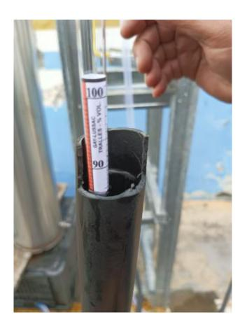
Nota. Se muestra el resultado de la primera prueba realizada con el valor de 78°C de temperatura e implementando el proceso de realimentación del alcohol etílico con una medición de 84° de etanol.
