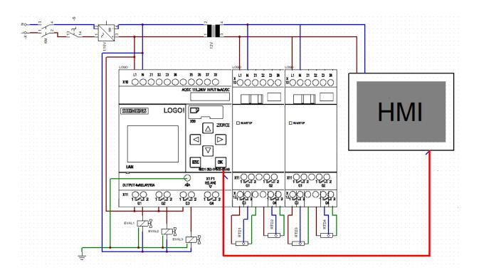
Nota. La imagen presenta el esquema de conexión eléctrica de los dispositivos de control PLC con su conexión ethernet al HMI junto con las electroválvulas y sensores de temperatura RTD junto con su alimentación de 110V y 12V, además de sus protecciones.
