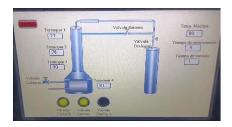
Nota. En la imagen se puede observar que las luces piloto de la válvula de los calderines y la válvula de retorno están encendidas y la temperatura del sensor 1 está en 77°C, por lo que el proceso de retroalimentación está activo.
