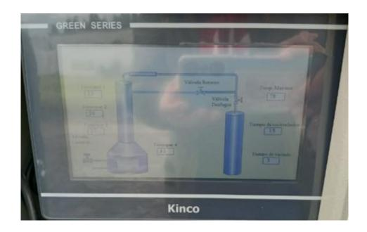
Nota. Imagen que se muestra la primera vez que se encendió el sistema y se pudo ver que el HMI funciona correctamente junto con la visualización de datos de temperatura.
