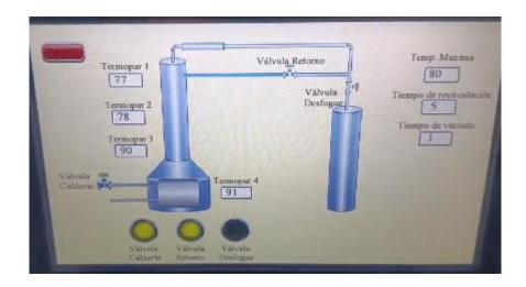
*Nota.* Se muestra el rediseño implementado en el HMI incluyendo los pilotos para poder observar de mejor manera el proceso.
