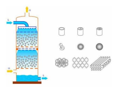
Nota. En la imagen se puede apreciar la estructura interna de una columna de destilación de relleno la cual está compuesta por dos etapas de destilación, separadas por un espacio el cuál varía de acuerdo con el diámetro de la columna y al relleno que esta use. Tomado de Diseño y construcción de una torre de destilación con rectificación para la purificación del thinner usado procedente de las mecánicas automotrices por Sandra Isabel Adriano Yubailli y Verónica Patricia Valle Freire, 2012.
