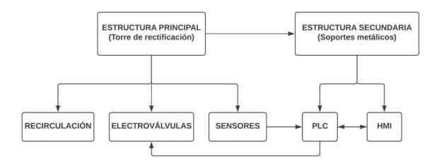
*Nota.* Se muestra la arquitectura de diseño de la estructura del prototipo en el cual está la estructura principal y la secundaria en las cuales se montan el resto de los subsistemas.
