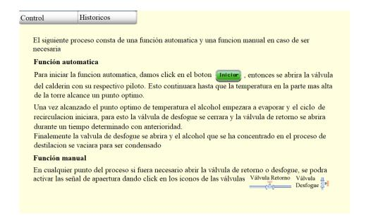
Nota. En esta pestaña se presenta las instrucciones de uso del HMI para poder realizar el proceso de destilación del etanol.
