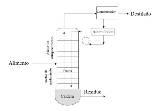
Nota. En la figura se observa el diagrama de representación de una columna de destilación de platos y sus partes. Tomado de *Diseño y construcción de una torre de destilación con rectificación para la purificación del thinner usado procedente de las mecánicas automotrices* por Sandra Isabel Adriano Yubailli y Verónica Patricia Valle Freire, 2012.
