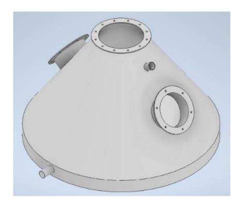
Nota. En la imagen se muestra la vista isométrica del diseño de la olla la cual es parte del proceso de destilación. Este diseño es basado en los diseños para la destilación artesanal de etanol. Tomado de Grupo Pacheco, s/f.
