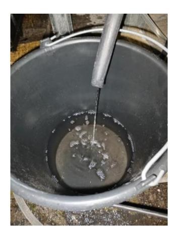
Nota. En la figura se muestra como se recoge el producto final, es decir, el alcohol etílico después de la destilación.
