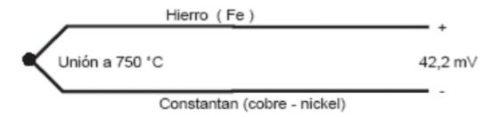
Nota. Podemos apreciar esquema de una termocupla formada por un alambre de hierro y otro de constantan (cobre y níquel). Tomado de Sensores de temperatura por Aragonés, J. B., Gómez, C. G., Zaragozí, B. Z., Martínez, A. G., Campos, D. M., & Llinares, A. G., 2003.
