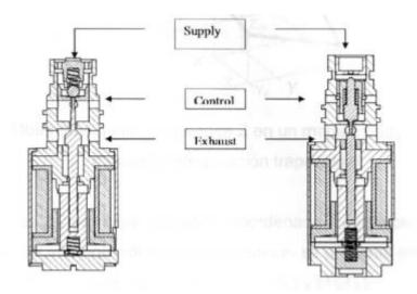
Nota. La figura representa el corte seccional de una válvula solenoide de purga variable VBS la cual tiene tres partes: Alimentación, control y escape. Tomado de *Identificación y*
