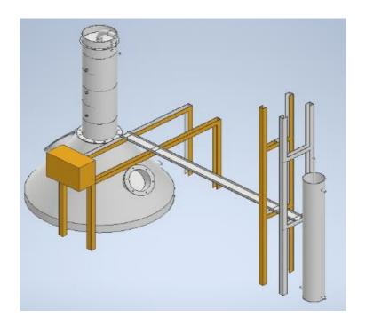
*Nota.* Se muestra una vista isométrica del diseño del sistema estructural de cableado y control.
