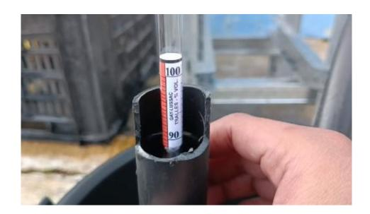
Nota. En la imagen se muestra cómo se realiza la prueba manual de concentración de alcohol con la ayuda de un densímetro medidor de alcohol que muestra la medición de 88% de concentración de alcohol.
