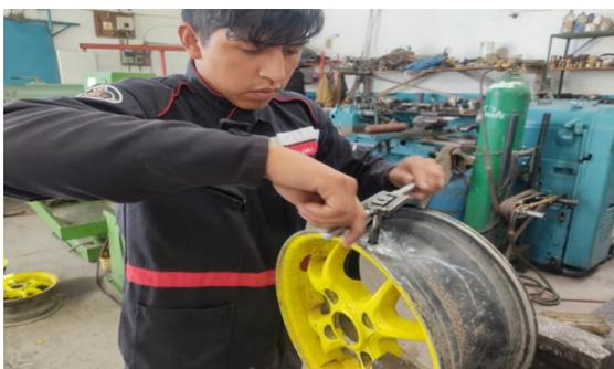
*Nota.* En la figura se observa el proceso de inserción de machuelo en el aro del vehículo.
