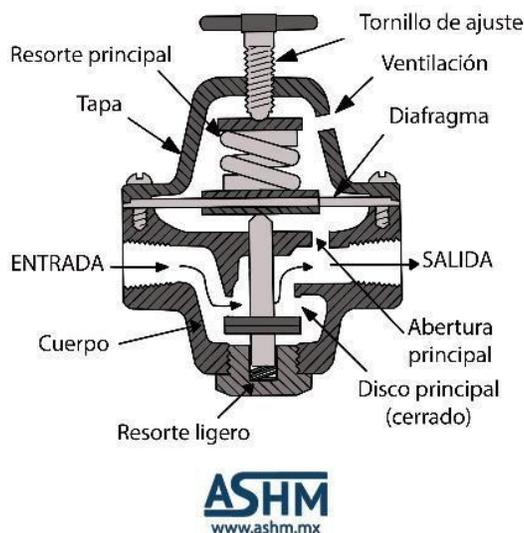
*Nota.* En la figura se observa el regulador de presión con orificio de escape. Tomado de (S.A. de C.V., 2018)
