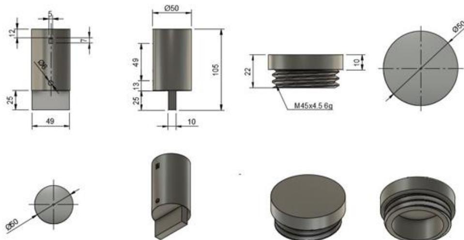
*Nota.* En la figura se detalla las dimensiones del armazón que contendrá el circuito del sensor sujetas en el neumático.
