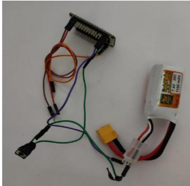
*Nota.* En la figura se muestra la conexión de circuito electrónico para el sensor de presión.
