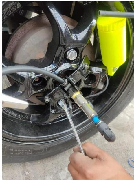
*Nota.* En la figura se visualiza el acoplamiento de la base y el conector giratorio que se instala en cada rueda para la auto compensación de aire.
