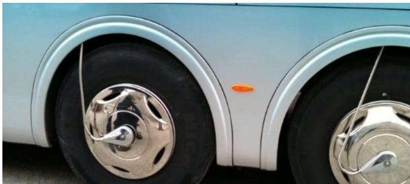
*Nota.* En la figura se visualiza el sistema de auto compensación de aire a los neumáticos.
