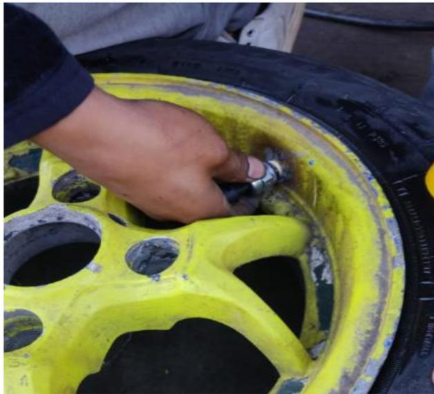
*Nota.* En la imagen se visualiza el sensor de aire ya instalado en el aro del vehículo.
