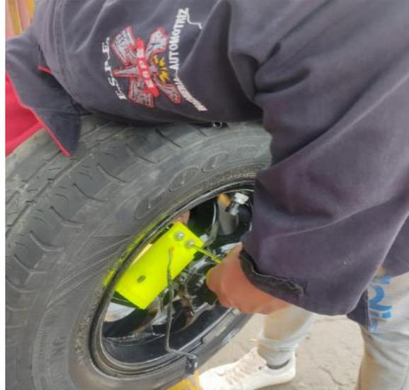
*Nota.* En la figura se muestra el proceso de sujeción del componente electrónico de monitoreo.
