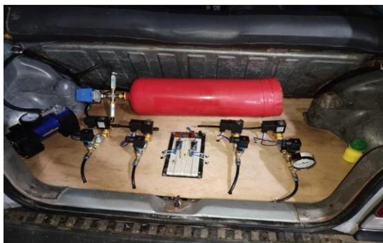
*Nota.* En la figura se visualiza el ensamble del circuito de alimentación neumático con salidas para cada rueda.
