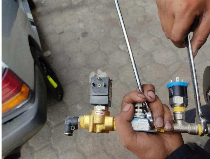
*Nota.* En la figura se visualiza la conexión de los diferentes componentes neumáticos para su posterior ensamble en el vehículo.
