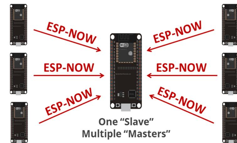
*Nota.* En la figura se muestra la comunicación de varios maestros y un esclavo. Tomado de (Carrasco, 2021)
