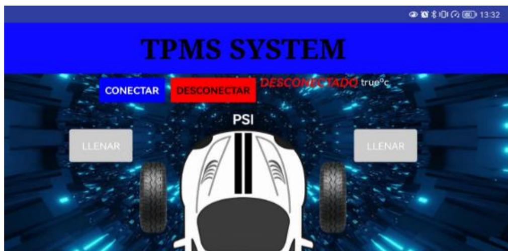
*Nota.* En la figura se muestra la aplicación Android que se proyecta en la pantalla para el monitoreo de presión.
