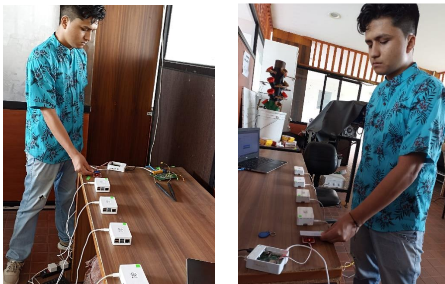
Fig. 20 Escenario implementado de escaneo de Tag/Tarjetas RFID
